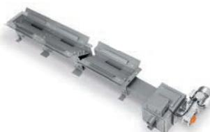
Vite senza fine per silos in muratura
