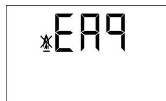
Se produce por cualquier anomalía que pudiera existir en el quemador (18) o en la instalación de combustible. Para desbloquear, pulsar el pulsador luminoso que se enciende en el quemador.
