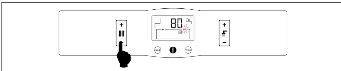
La selección de la temperatura deseada de funcionamiento de la caldera se realiza mediante el selector táctil indicado en la figura. Para seleccionar la temperatura deseada tocar en los símbolos "+" o "-" para incrementar o disminuir el valor de la temperatura, respectivamente. Una vez seleccionada la temperatura, en unos pocos segundos la pantalla regresará a la situación de reposo.
