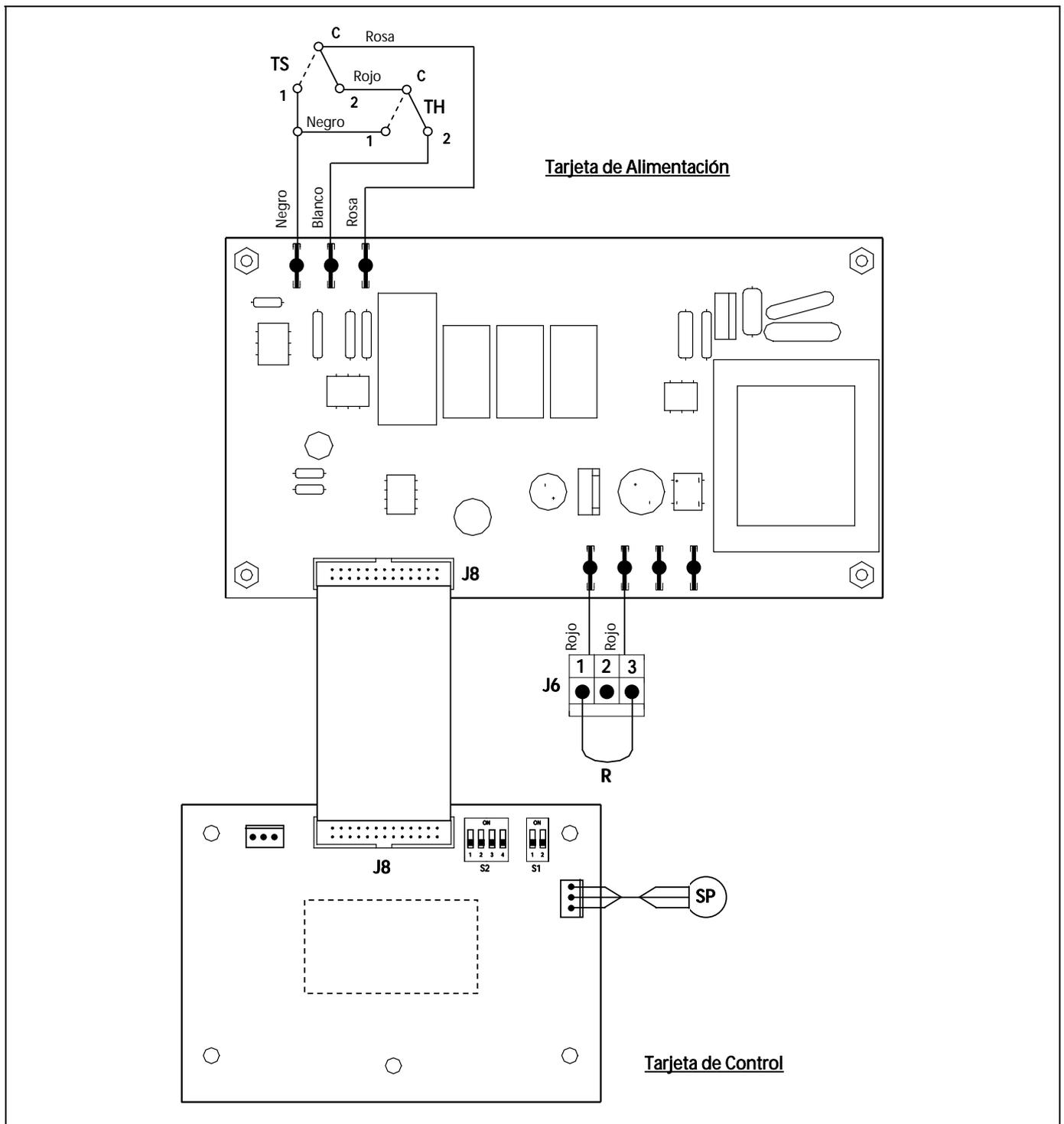
**TS:** Termostato de Seguridad.
