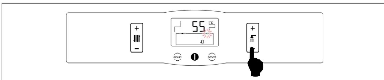
La selección de la temperatura de A.C.S. deseada se realiza mediante el selector táctil indicado en la figura. Para seleccionar la temperatura deseada tocar en los símbolos "+" o "-" para incrementar o disminuir el valor de la temperatura, respectivamente. Una vez seleccionada la temperatura, en unos pocos segundos la pantalla regresará a la situación de reposo. El rango de temperatura de consigna de A.C.S. seleccionable es de OFF, 15 - 65 °C.
