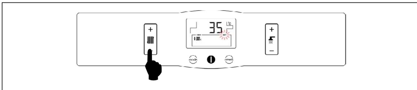
Cuando la caldera es suministrada con el Kit opcional de Suelo Radiante SRX2/EV integrado, la selección de la temperatura deseada de funcionamiento de de ida de la instalación se realiza mediante el selector táctil indicado en la figura. Para seleccionar la temperatura deseada tocar en los símbolos "+" o "-" para incrementar o disminuir el valor de la temperatura, respectivamente. Una vez seleccionada la temperatura, en unos pocos segundos la pantalla regresará a la situación de reposo.
