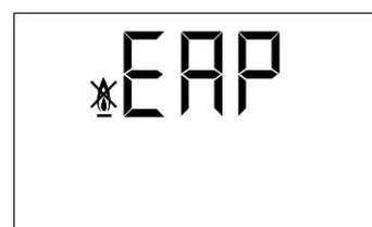
Se produce cuando la presión de la caldera baja por debajo de 0,5 bar, evitando que ésta funcione cuando se vacía de agua la instalación, bien por tener alguna fuga o por operaciones de mantenimiento. Para desbloquear, se deberá llenar de nuevo la instalación, hasta que en el parámetro de "presión de la caldera" del display (19) se visualice una presión entre 1 y 1,5 bar.
