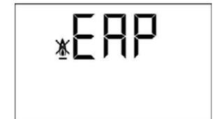
Si verifica quando la pressione della caldaia scende al di sotto di 0,5 bar, evitando che questa funzioni quando l'impianto è privo di acqua a causa di una perdita o per operazioni di manutenzione. Per sbloccare, è necessario riempire nuovamente l'impianto finché il parametro *"pressione della caldaia"* sul display **(19)** non indichi una pressione compresa tra 1 e 1,5 bar.
