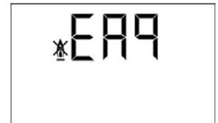
Si verifica per qualsiasi anomalia presente nel bruciatore **(18)** o nell'impianto del combustibile. Per sbloccare, premere il pulsante luminoso che si accende sul bruciatore.
