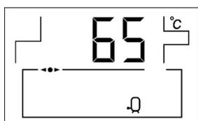
Temperatura real del Agua Caliente Sanitaria (con interacumulador).
