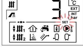
Contraste de la pantalla deseado, ajustado mediante selector táctil de la parte derecha del display **(16)**.
