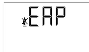
Se produce cuando la presión de la caldera baja por debajo de 0,5 bar, evitando que ésta funcione cuando se vacía de agua la instalación, bien por tener alguna fuga o por operaciones de mantenimiento. Para desbloquear, se deberá llenar de nuevo la instalación, hasta que en el parámetro de *"presión de la caldera"* del display **(11)** se visualice una presión entre 1 y 1,5 bar.
