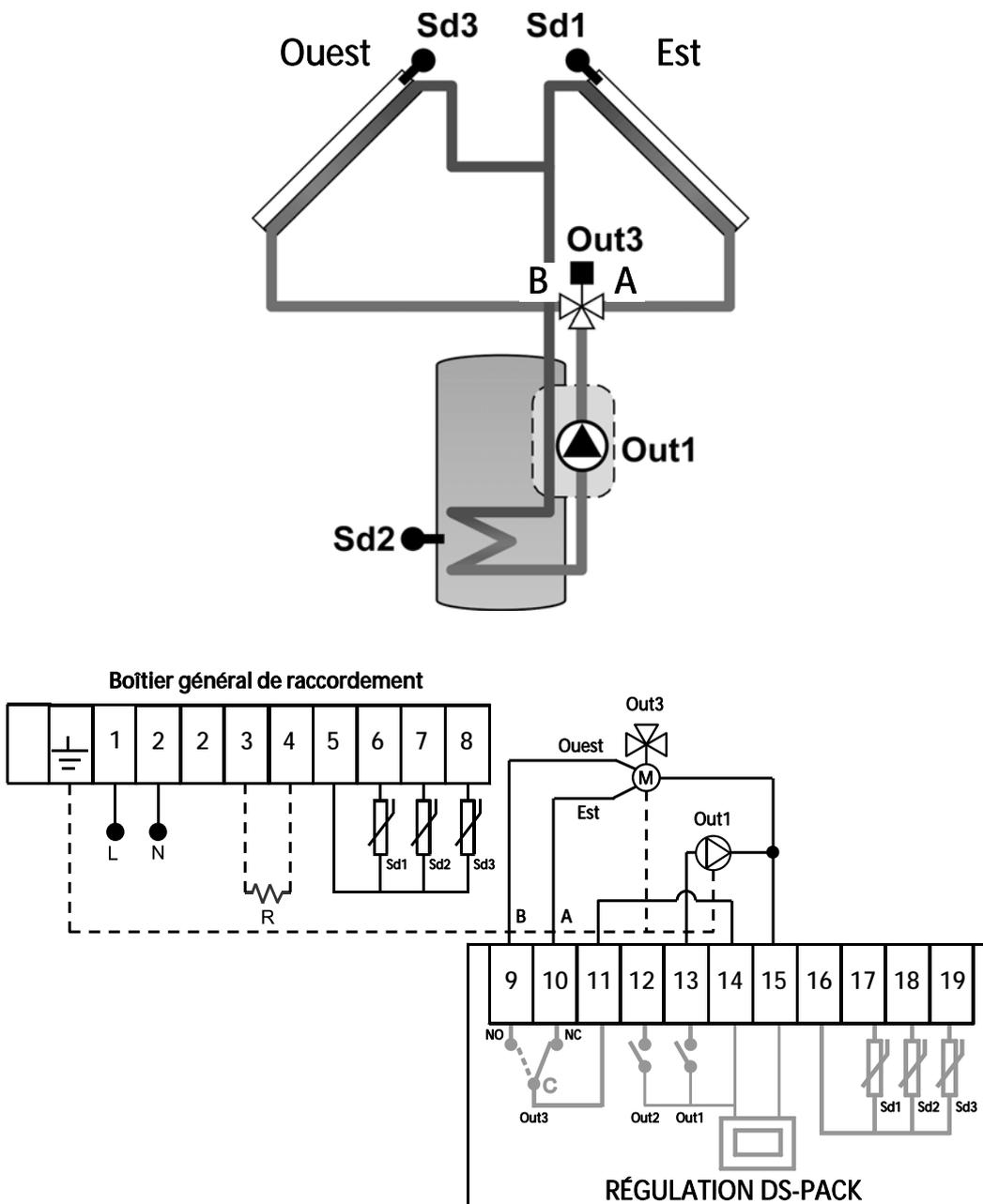
Le câble d'ouverture de la **voie A** (orientation où aura été installée la sonde **Sd1**) doit être connecté à la borne n° 10 du boîtier de raccordement.
