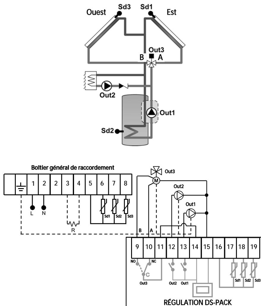
Le fil d'ouverture de la **voie A** (orientation où aura été installée la sonde **Sd1**) se connecte à la borne n° 10 du boîtier de raccordement.
