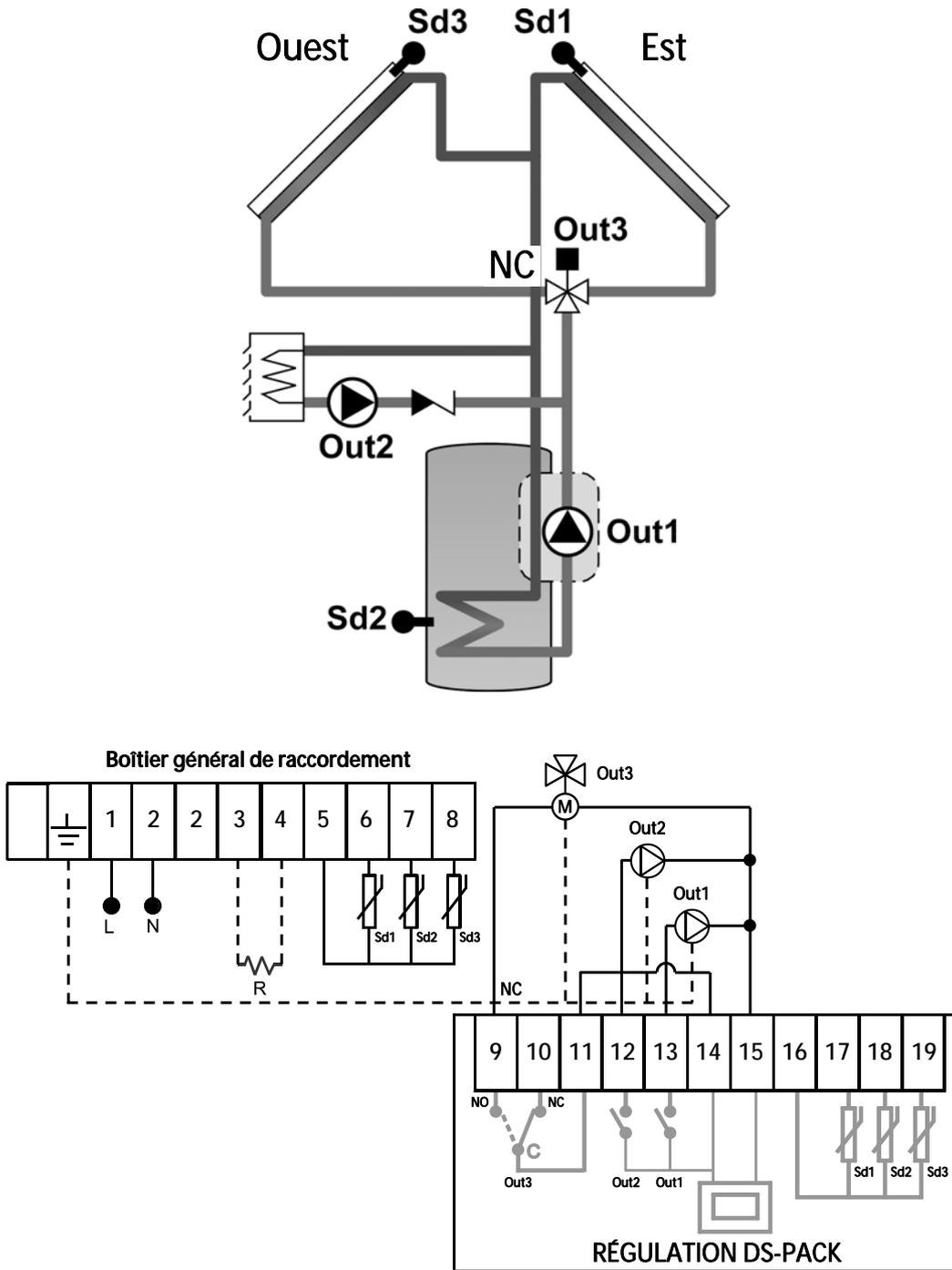
La vanne se monte de telle sorte que la voie qui reste fermée lorsque **"il n'y a pas de tension"** ("**NC**" sur la figure) dévie le flux vers l'orientation où aura été installée la sonde de température **Sd3**.
