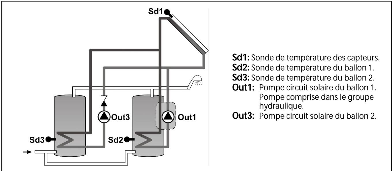
Dans ce mode de fonctionnement, le système de valorisation solaire pour ECS est le système standard qui pilote 2 ballons d'ECS solaires en même temps (en parallèle). Son fonctionnement consiste à activer la valorisation solaire si la température de l'un des ballons (lue sur les sondes **Sd2** ou **Sd3**) est inférieure à la consigne **LSR** - 1 °C et à désactiver la valorisation solaire lorsque la température des deux ballons est supérieure à la consigne **LSR**.
