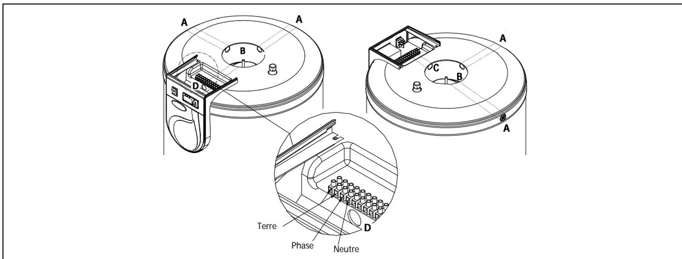
Pour réaliser le branchement des autres composants de l'installation (sondes, pompes de circulation, ...), suivre scrupuleusement les instructions de chaque "**mode de fonctionnement**", au § "*Fonctionnement*". Le branchement électrique doit respecter les mesures de précaution suivantes:
