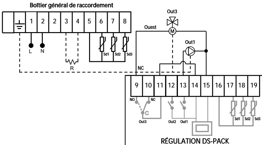
La vanne se monte de façon à ce que la voie qui reste fermée quand "il n'y a pas de tension" ("NC" sur la figure) dévie le flux vers l'orientation où aura été installée la sonde de température **Sd3**.
