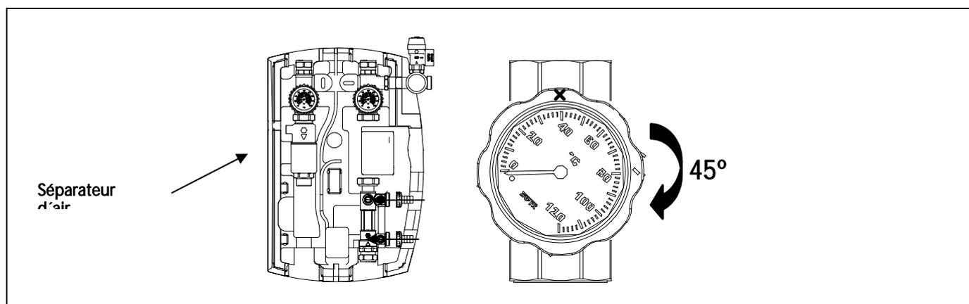
Commencer le remplissage par le liquide antigel calculé pour obtenir le mélange adéquat, puis remplir le reste de l'installation avec de l'eau du réseau. Lorsque la dureté de l'eau est supérieure à 25-30 °F, il convient d'utiliser de l'eau déminéralisée ou traitée.
