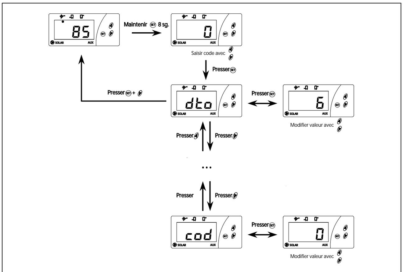
Avant de régler les paramètres techniques de l'unité de régulation, sélectionner le "mode de fonctionnement" de l'installation, car un changement de mode de fonctionnement ramène tous les paramètres aux valeurs par défaut d'usine.
