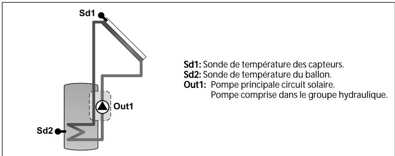
Il s'agit du mode de fonctionnement standard et le plus simple pour un système de valorisation solaire pour ECS. Son fonctionnement consiste à activer la valorisation solaire si la température de celle-ci (lue sur la sonde **Sd2**) est inférieure à la consigne **LSA** - 1 °C et à désactiver la valorisation quand la température du ballon est supérieure à la consigne **LSA**.
