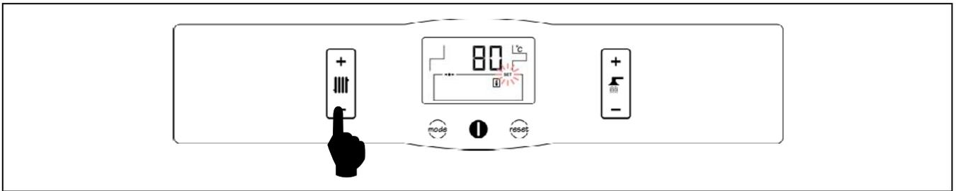
La selección de la temperatura deseada de funcionamiento de la caldera se realiza mediante el selector táctil indicado en la figura. Para seleccionar la temperatura deseada tocar en los símbolos "+" o "-" para incrementar o disminuir el valor de la temperatura, respectivamente. Una vez seleccionada la temperatura, en unos pocos segundos la pantalla regresará a la situación de reposo.
