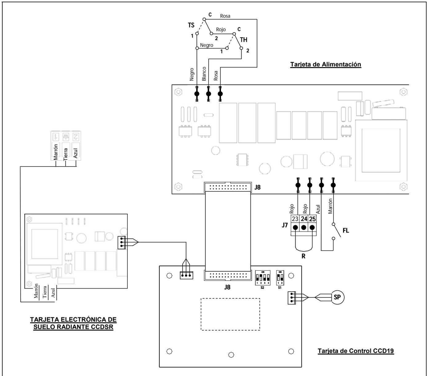
**TS:** Termostato de Seguridad.
