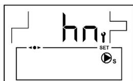
Parámetro de operación manual de las bombas solares. Este parámetro deberá ser manipulado exclusivamente por personal cualificado, durante las maniobras de puesta en funcionamiento del circuito solar que integra la caldera.
