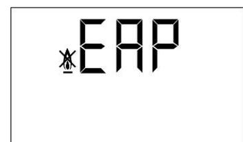
Se produce cuando la presión de la caldera baja por debajo de 0,5 bar, evitando que ésta funcione cuando se vacía de agua la instalación, bien por tener alguna fuga o por operaciones de mantenimiento. Para desbloquear, se deberá llenar de nuevo la instalación, hasta que en el parámetro de "presión de la caldera" del display (24) se visualice una presión entre 1 y 1,5 bar.
