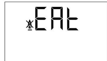
Se producirá siempre que la caldera sobrepase los 110 °C de temperatura. Para desbloquear, se deberá esperar a que la temperatura de caldera baje de 100 °C y se deberá pulsar el botón incorporado en el termostato de seguridad, situado en el interior de la caldera en la parte inferior del cajón eléctrico, después de haber soltado primeramente el tapón que tapa este botón.
