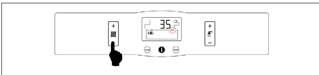
Cuando la caldera es suministrada con el Kit opcional de Suelo Radiante SRS2/EV integrado, la selección de la temperatura deseada de funcionamiento de ida de la instalación se realiza mediante el selector táctil indicado en la figura. Para seleccionar la temperatura deseada tocar en los símbolos "+" o "-" para incrementar o disminuir el valor de la temperatura, respectivamente. Una vez seleccionada la temperatura, en unos pocos segundos la pantalla regresará a la situación de reposo.
