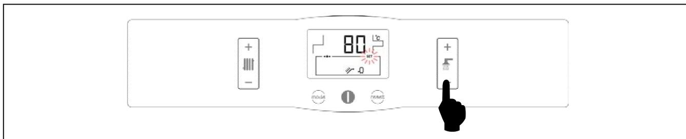
La selección de la temperatura de A.C.S. del acumulador solar deseada se realiza navegando con el botón táctil MODE hasta la opción de visualización de "consigna de temperatura de ACS del acumulador solar", una vez situada la pantalla en esta opción, seleccionar la temperatura deseada tocando en los símbolos "+" o "-" para incrementar o disminuir el valor de la temperatura, respectivamente. El rango de temperatura de consigna de A.C.S. del acumulador solar seleccionable es de 10 - 80 °C.
