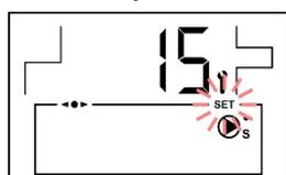
Tiempo para el cambio de velocidad de la bomba solar. Este parámetro deberá ser manipulado exclusivamente por personal cualificado. Un valor erróneo de este parámetro puede provocar un malfuncionamiento del circuito solar de la caldera.
