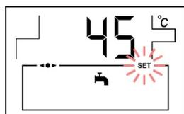
Consigna de temperatura de A.C.S. instantánea de apoyo, seleccionada mediante el selector táctil correspondiente **(29)**.
