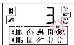
Contraste de la pantalla deseado, ajustado mediante el selector táctil de la parte derecha del display **(24)**.
