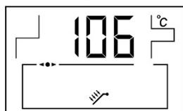
Temperatura real del Captador Solar.
