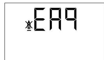
Se produce por cualquier anomalía que pudiera existir en el quemador (1) o en la instalación de combustible. Para desbloquear, pulsar el pulsador luminoso que se enciende en el quemador.
