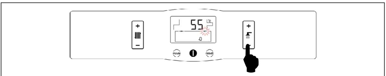
La selección de la temperatura de A.C.S. deseada se realiza mediante el selector táctil indicado en la figura. Para seleccionar la temperatura deseada tocar en los símbolos "+" o "-" para incrementar o disminuir el valor de la temperatura, respectivamente. Una vez seleccionada la temperatura, en unos pocos segundos la pantalla regresará a la situación de reposo. El rango de temperatura de consigna de A.C.S. seleccionable es de OFF, 30 - 65 °C.
