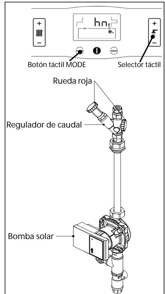
**ATENCIÓN:** El caudal del circuito solar se debe regular a 2 l/min. En las instalaciones en las que no se alcance un caudal de 2 l/min., se recomienda dejar el regulador de caudal totalmente abierto.
