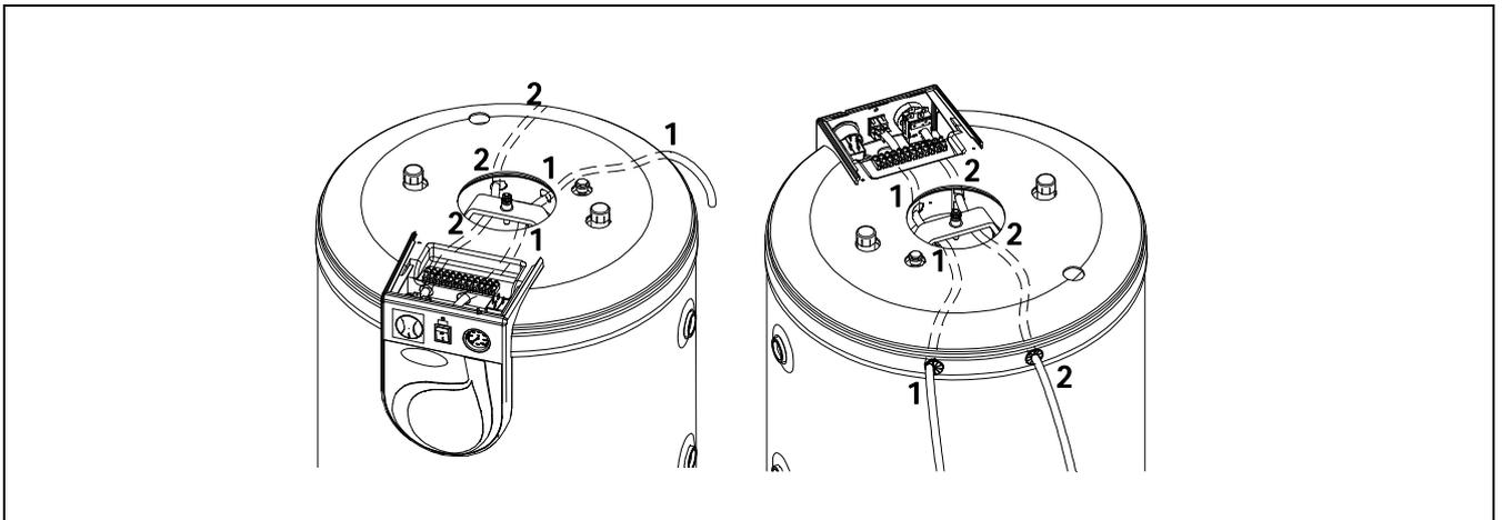
Además, el depósito **BT DUO ME** incorpora las bornas nº **9** y **10** preparadas para la conexión de un termostato o cronotermostato ambiente para gestionar la demanda de calefacción de la instalación. La instalación de tuberías hidráulicas, si es metálica (cobre, hierro;...), deberá estar conectada a tierra.
