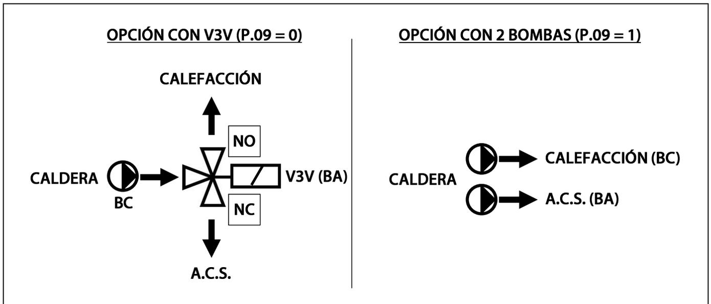
Para la instalación con 2 bombas se deberá instalar un separador hidráulico o depósito de inercia entre la caldera y el interacumulador.
