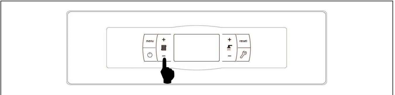
La selección de la temperatura deseada de funcionamiento de la caldera se realiza mediante el selector táctil indicado en la figura. Para seleccionar la temperatura deseada tocar en los símbolos "+" o "-" para incrementar o disminuir el valor de la temperatura, respectivamente. Una vez seleccionada la temperatura, en unos pocos segundos la pantalla regresará a la situación de reposo. El rango de consigna de temperatura de caldera seleccionable es de OFF, 75 - 85 °C.
