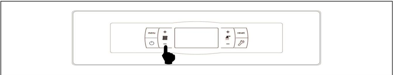
La selección de la temperatura deseada en el depósito de inercia se realiza mediante el selector táctil indicado en la figura. Para seleccionar la temperatura deseada tocar en los símbolos "+" o "-" para incrementar o disminuir el valor de la temperatura, respectivamente. Una vez seleccionada la temperatura, en unos pocos segundos la pantalla regresará a la situación de reposo. El rango de consigna de temperatura seleccionable es de OFF, 30 - 80 °C.
