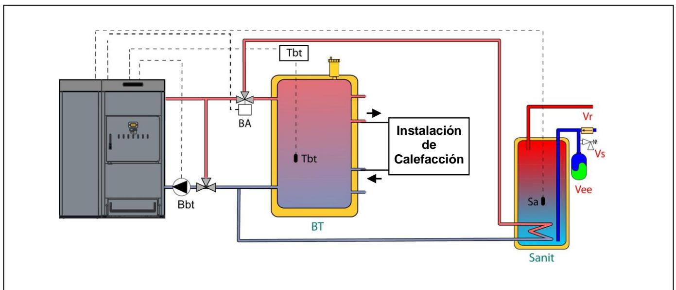
Una vez realizada la instalación hidráulica de todos los componentes de la instalación, para realizar correctamente la conexión eléctrica del depósito de inercia BT con la caldera **DualTherm** se debe proceder de la siguiente manera:
