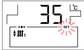
Temperatura di setpoint di mandata dell'impianto a pavimento radiante selezionata tramite il selettore touch corrispondente (20).
