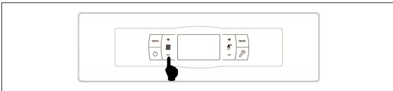
La sélection de température souhaitée du ballon tampon est réalisée à l'aide du sélecteur tactile indiqué sur le schéma. Pour sélectionner la température souhaitée, appuyer respectivement sur les symboles "+" ou "-" afin d'augmenter ou de diminuer la valeur de la température. Après avoir sélectionné la température, un retour à l'écran de repos interviendra après quelques secondes. La plage de température de consigne sélectionnable est de : OFF, 30 - 80°C.
