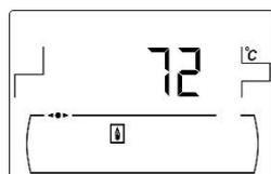
Température réelle de chaudière.
