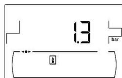
Pression d'eau de la chaudière, mesurée par le capteur de pression d'eau.
