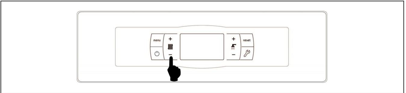
La sélection de température souhaitée de la chaudière est réalisée à l'aide du sélecteur tactile indiqué sur le schéma. Pour sélectionner la température souhaitée, appuyer respectivement sur les symboles "+" ou "-" afin d'augmenter ou de diminuer la valeur de la température. Après avoir sélectionné la température, un retour à l'écran de repos interviendra après quelques secondes. La plage de température de consigne sélectionnable est de : OFF, 30 - 80°C.
