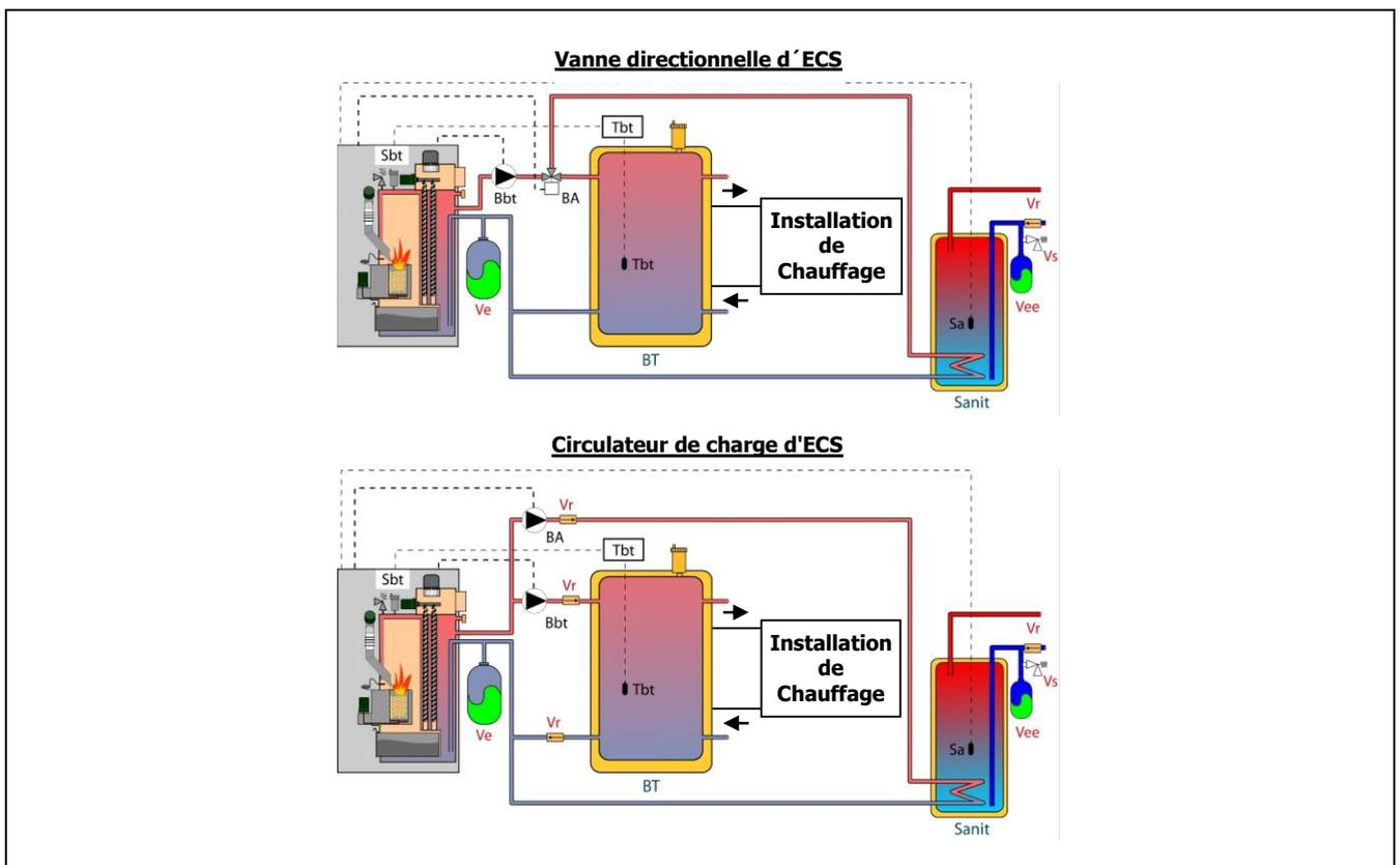
Après avoir réalisé l'installation hydraulique de tous les composants de l'installation, procéder de la manière suivante pour réaliser le raccordement électrique du ballon tampon BT avec la chaudière **BioClass iC** :
