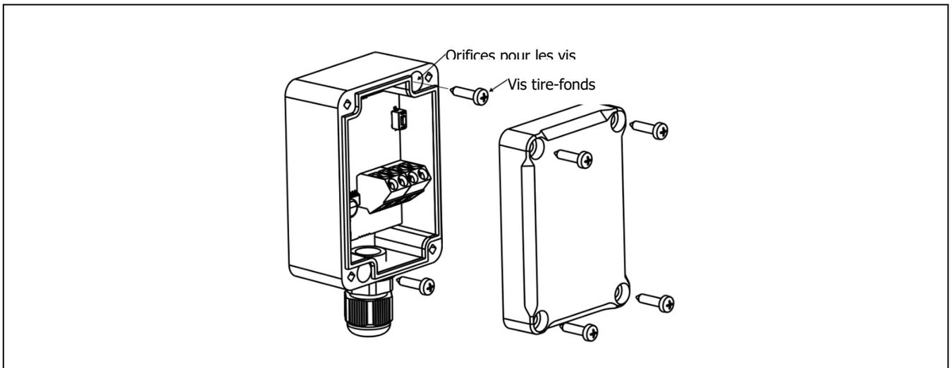
**IMPORTANT :** L'installation du module radio à l'intérieur d'une carcasse en métal, par exemple, à l'intérieur de la chaudière, dans un boîtier métallique, etc., atténuera le signal radio et, par conséquent, interférera et réduira la couverture du signal radio du module.
