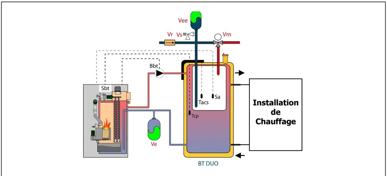
Après avoir réalisé l'installation hydraulique de tous les composants de l'installation, pour réaliser correctement la connexion électrique du ballon tampon BT-DUO avec la chaudière **BioClass iC** il faut procéder de la manière suivante :
