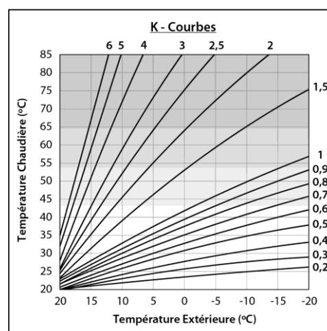
La courbe K optimale pour chaque circuit de chauffage peut varier en fonction du type du circuit, les conditions d'isolement du bâtiment et la position de la sonde. Malgré tout, la recommandation générale est que pour les circuits de chauffage de haut température (p. e. circuit direct aux radiateurs) la courbe K choisie soit égale ou supérieure à 1, et pour circuits de basse température (p.ex. circuit mélangé de "plancher chauffant") la courbe K choisie soit égale ou inférieure à 0,8.
