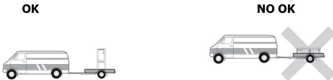
El embalaje de la bomba de calor incorpora una etiqueta "indicadora de vuelco" para asegurarse de que la máquina no ha sido tumbada durante su transporte y almacenamiento. Antes de recibir la máquina de su proveedor (distribuidor), chequear el estado de dicha etiqueta y rechazar el aparato sin desembalarlo si el chivato de la misma indica que ha sido volcada.
