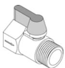
**Rubinetto di scarico:** viene fornito all'interno della macchina, fissato con una flangia a un piede del compressore. Questo rubinetto deve essere montato alla presa di scarico della parte posteriore della pompa di calore prima di riempire d'acqua il circuito di riscaldamento/climatizzazione (vedere "Schemi e ingombri").
