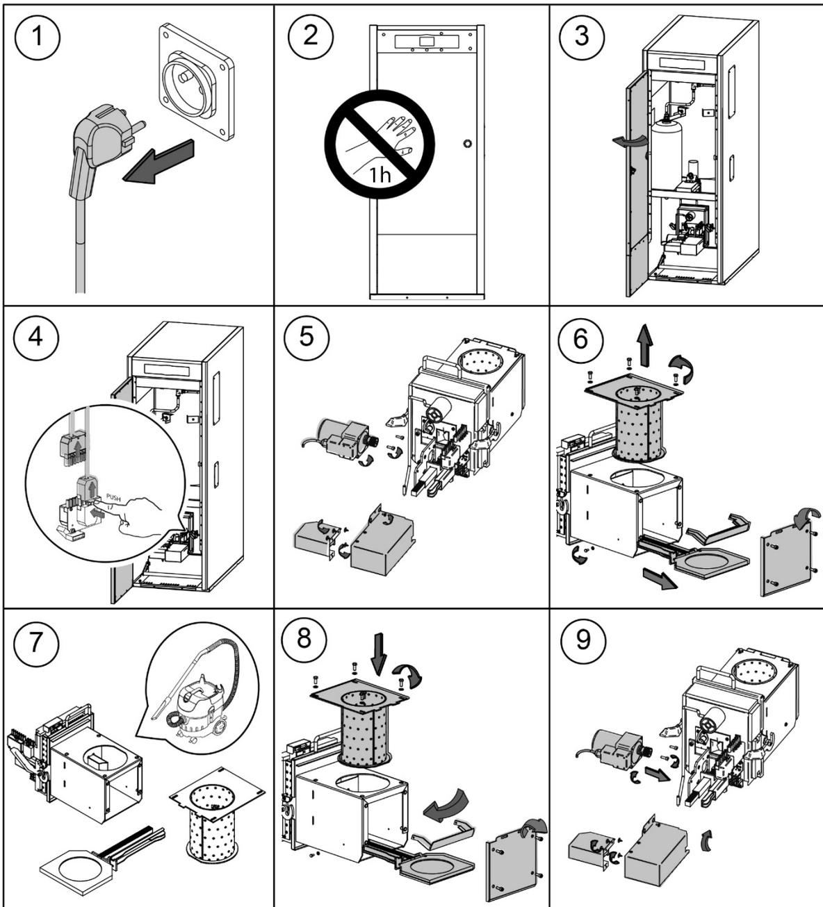
Dependiendo de la cantidad de pellets de madera quemados o de su calidad, el usuario debe limpiar las paredes del quemador utilizando un cepillo adecuado, para evitar una formación demasiado grande de ceniza.
