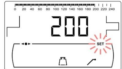
Este proceso se debe realizar un mínimo de 2 veces para asegurar que la cantidad de combustible introducida es la correcta. A continuación se describen los pasos a seguir para la correcta calibración del alimentador:
