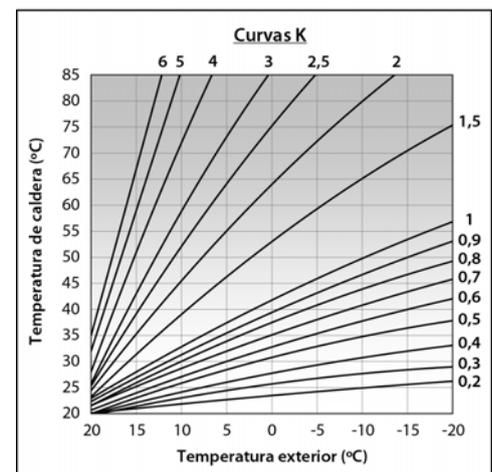
Dependiendo del tipo de circuito, las condiciones de aislamiento del edificio y ubicación de la sonda exterior variará la curva K óptima para cada circuito de calefacción. Como regla general se recomienda que, para circuitos de calefacción de alta temperatura (p.e. circuito directo de "radiadores") se seleccione una curva K igual o superior a 1, y para circuitos de baja temperatura (p.e. circuito mezclado de "suelo radiante") se seleccione una curva K igual o inferior a 0,8.
