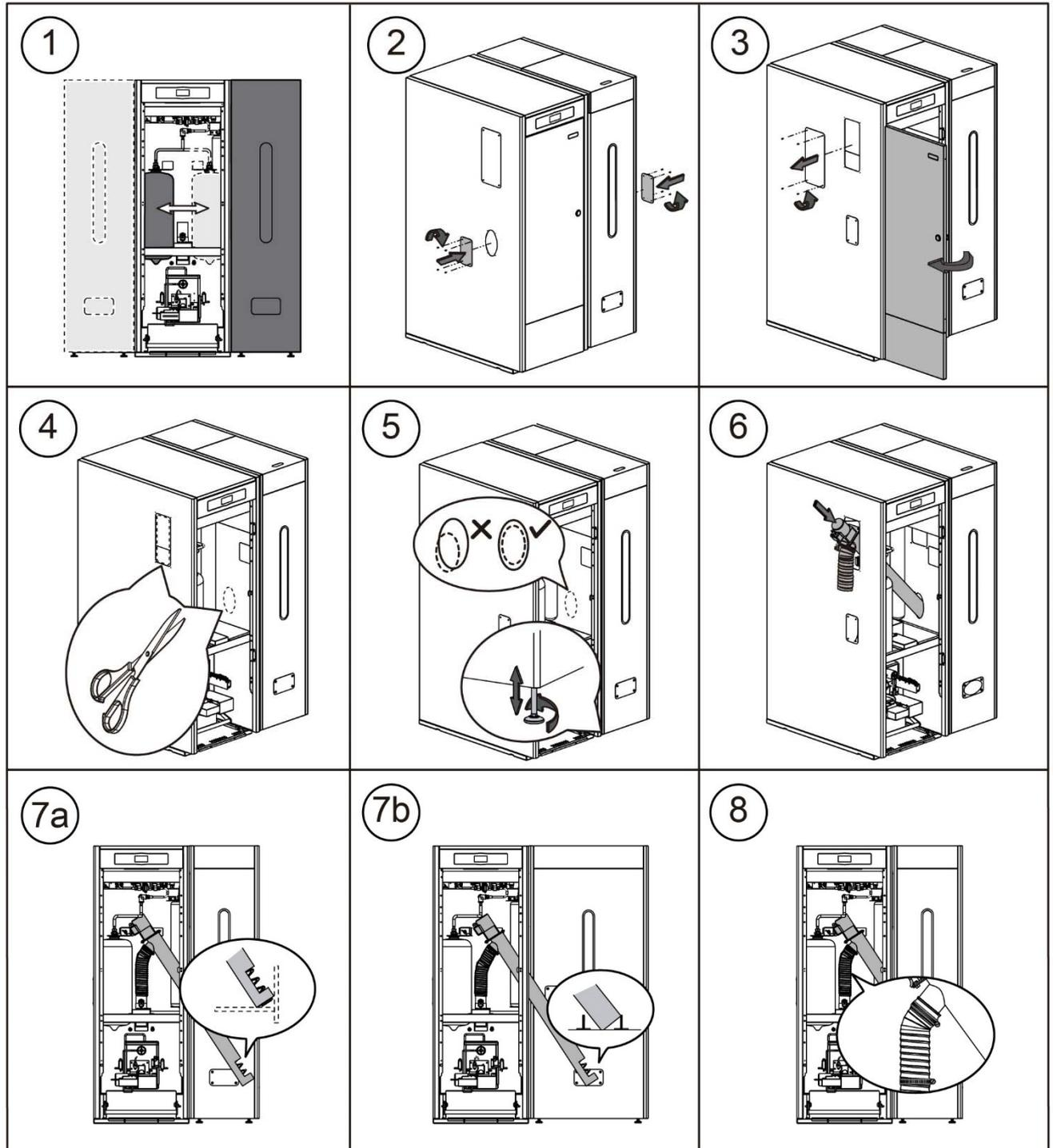
**IMPORTANT :** S'assurer que les orifices ovales latéraux de la chaudière et du réservoir d'alimentation soient à la même hauteur pour pouvoir introduire correctement le vis d'alimentation. Pour cela, effectuer les réglages nécessaires, tant en hauteur (avec les pieds réglables) qu'en profondeur (en situant correctement le réservoir d'alimentation).
