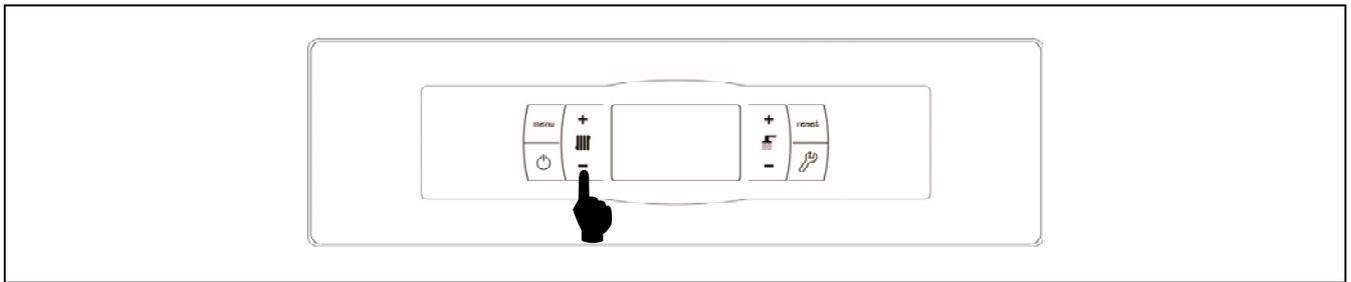
La sélection de température souhaitée de la chaudière est réalisée à l'aide du sélecteur tactile indiqué sur le schéma. Pour sélectionner la température souhaitée, appuyer respectivement sur les symboles "+" ou "-" afin d'augmenter ou de diminuer la valeur de la température. Après avoir sélectionné la température, un retour à l'écran de repos interviendra après quelques secondes. La plage de température de consigne sélectionnable est de : OFF, 30 - 80°C.
