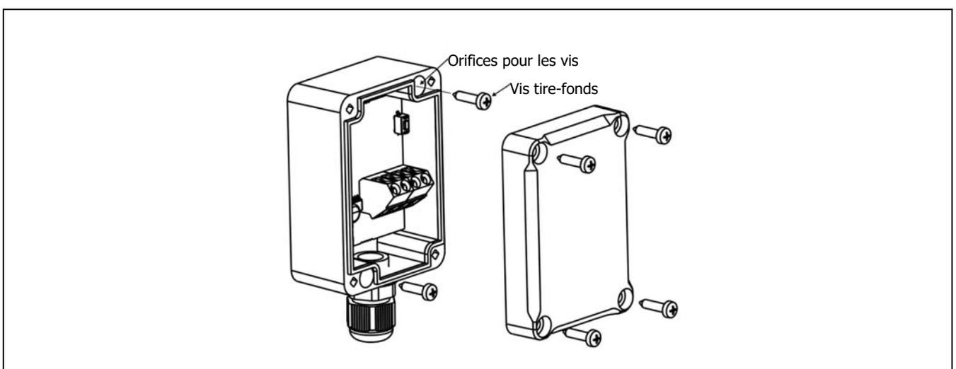
**IMPORTANT :** L'installation du module radio à l'intérieur d'une carcasse en métal, par exemple, à l'intérieur de la chaudière, dans un boîtier métallique, etc., atténue le signal radio et, par conséquent, interférera et réduira la couverture du signal radio du module.
