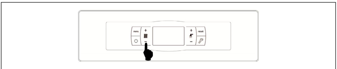
La sélection de température souhaitée du ballon tampon est réalisée à l'aide du sélecteur tactile indiqué sur le schéma. Pour sélectionner la température souhaitée, appuyer respectivement sur les symboles "+" ou "-" afin d'augmenter ou de diminuer la valeur de la température. Après avoir sélectionné la température, un retour à l'écran de repos interviendra après quelques secondes. La plage de température de consigne sélectionnable est de : OFF, 30 - 80°C.
