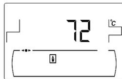
Température réelle de chaudière.
