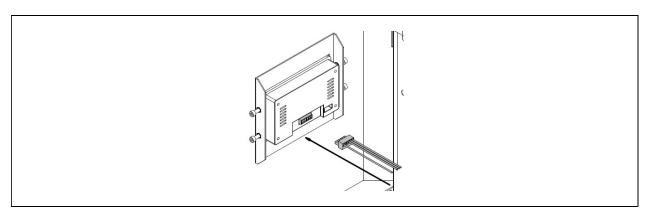
Antes de proceder a encender la bomba de calor, asegurarse que el otro extremo del cable que hemos conectado en el panel de mandos está conectado a la máquina exterior.
