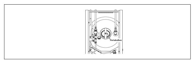
3. Volver a montar el techo, colocándolo en posición y presionando sobre los cuatro pivotes de anclaje.
