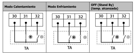
Las bornas **30**, **31** y **32** se suministran de fábrica con un puente conectado en cada una de ellas, por lo que, para instalar este tipo de termostato será necesario quitar **los dos** puentes y conectar el termostato según lo descrito en la siguiente figura:
