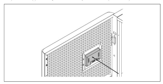
4. Ajustar los 4 tornillos apretando con la mano, hasta que quede fijado el panel de mandos. No es necesario utilizar una llave, es suficiente con el ajuste con la mano.
