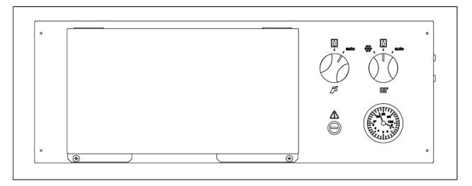
Para un mayor confort en calefacción, mediante el selector de calefacción (23) es posible cambiar el modo de funcionamiento y fuente de energía que trabajará en demanda calefacción.
