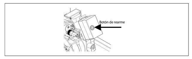
El LED multicolor del botón de rearme es el elemento indicador para el diagnóstico visual. Tanto el pulsador como el LED se ubican bajo la cubierta transparente del botón de rearme. En funcionamiento normal, los distintos estados de funcionamiento se indican en forma de códigos de color (consultar la tabla de códigos de color de abajo). Durante el arranque, la indicación tiene lugar según la siguiente tabla:
