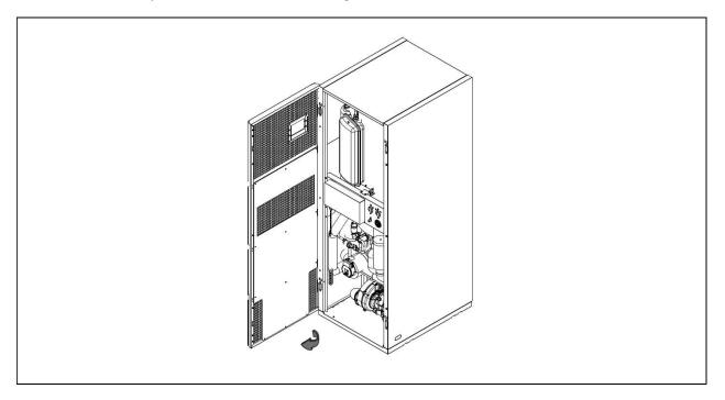
2. Apoyar con la mano por la parte exterior de la puerta del módulo **Fusion Hybrid Oil R**.
