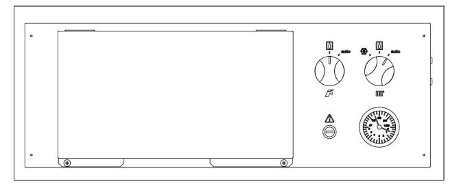
Girando el selector de ACS (22) a posición el módulo de apoyo pasa a ser la fuente principal de energía para demanda de ACS. La bomba de calor deja de gestionar la producción de ACS dejando al módulo el calentamiento y producción de ACS. La temperatura de ACS para este modo de funcionamiento pasará a ser la máxima seleccionable en la bomba de calor.
