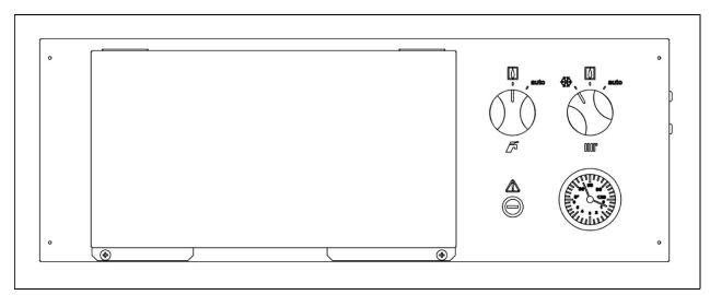
Combinado los modos de funcionamiento en el selector de calefacción (23) en posición 4 y el selector de ACS (22) en posición se consigue un funcionamiento ininterrumpido de climatización con la bomba de calor mientras que el módulo de apoyo pasa a gestionar la demanda de ACS.
