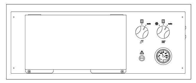
Este será el modo de funcionamiento por defecto del módulo **Fusion Hybrid Oil R** (con el selector de ACS (*22*) y el selector de calefacción (*23*) en posición auto. En este modo, el funcionamiento será gestionado por la bomba de calor **DUAL CLIMA R** tal y como se indica en el manual de instrucciones de la bomba de calor según configuración **P27=3**. Ver "*Configuración de las fuentes de energía auxiliar o de apoyo"*.
