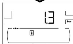
Pressione dell'acqua, rilevata dal sensore di pressione dell'acqua.
