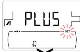
Temperatura di A.C.S. selezionata mediante il relativo selettore tattile **(19)**.
