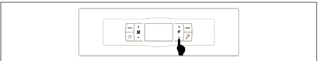
La selezione del setpoint di temperatura ACS desiderato avviene tramite il selettore touch indicato in figura. Per selezionare la modalità di funzionamento desiderata, toccare i simboli "+" o "-" per navigare tra le diverse modalità. Una volta selezionata la modalità, in pochi secondi lo schermo tornerà allo stato di riposo. È possibile selezionare tra tre setpoint ACS:
