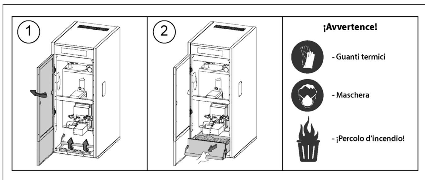
L'utente deve verificare regolarmente che il cassetto ceneri sia svuotato correttamente e controllare il livello di riempimento sul display della caldaia.
