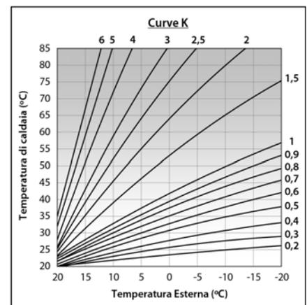
A seconda del tipo di circuito, le condizioni di isolamento dell'edificio e la posizione della sonda varierà la curva K ideale per ciascun circuito di riscaldamento. In ogni modo, per i circuiti di riscaldamento ad alta temperatura (ad es. il circuito diretto dei "radiator") si consiglia di selezionare una curva K uguale o superiore a 1, e per i circuiti a bassa temperatura (ad es. circuito misto con "suolo radiante") si consiglia di selezionare una curva K uguale o inferiore a 0,8.
