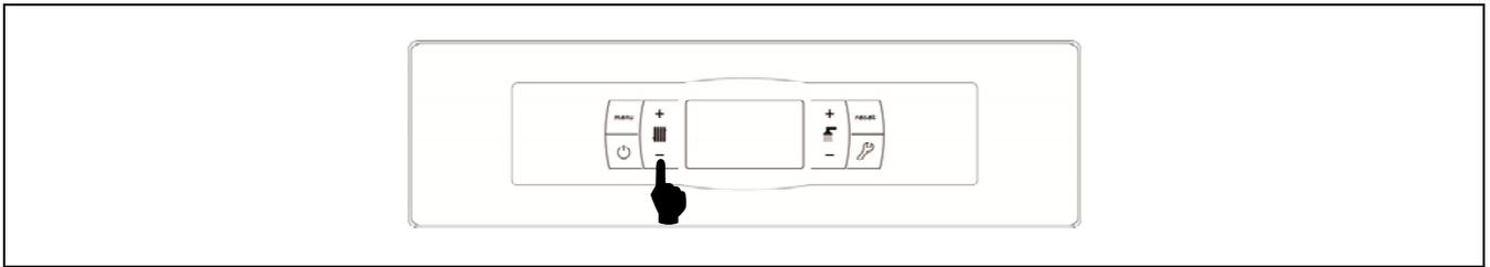
La selezione della temperatura desiderata nel serbatoio inerziale avviene mediante il selettore touch mostrato nella figura. Per selezionare la temperatura desiderata, toccare i simboli "+" o "-" rispettivamente per aumentare o diminuire il valore. Una volta selezionata la temperatura, dopo pochi secondi lo schermo torna alla situazione di riposo. L'intervallo della temperatura di setpoint selezionabile è compreso tra 30 e 80 °C e include OFF.
