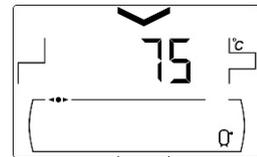
Temperatura effettiva del serbatoio inerziale (solo con serbatoio inerziale collegato e controllo mediante sonda di temperatura).
