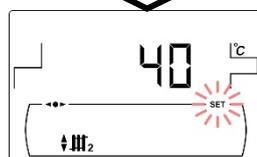
Temperatura di riferimento di ingresso del circuito miscelato n°2, selezionata mediante il relativo selettore tattile (18).
