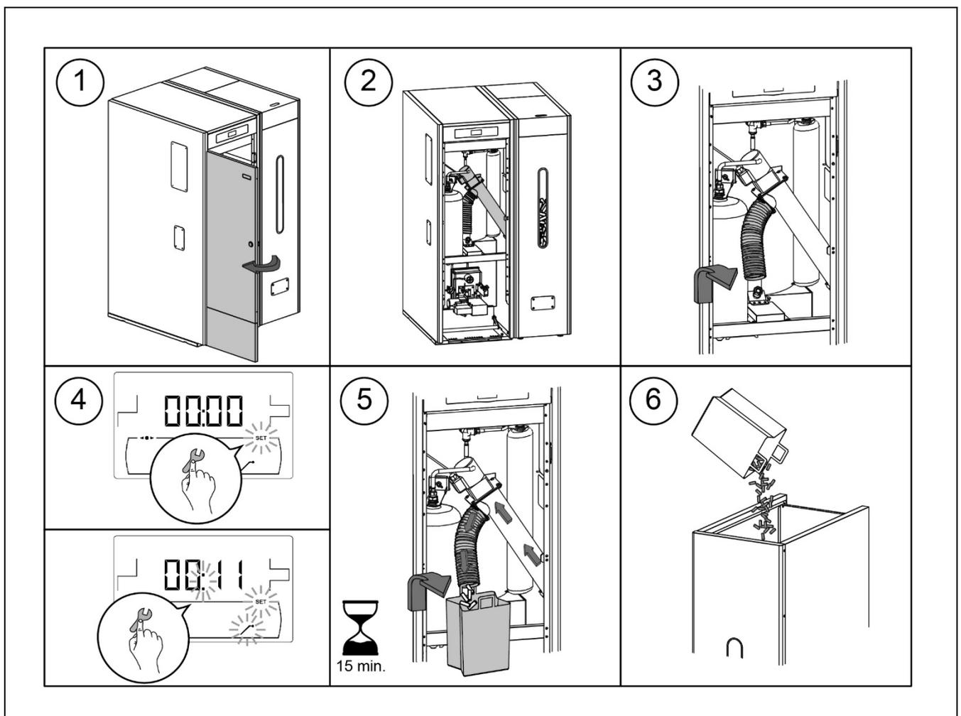
**IMPORTANTE:** È assolutamente necessario sfiatare l'alimentatore della caldaia prima della messa in funzione e nel caso in cui il serbatoio di riserva rimanga senza combustibile.
