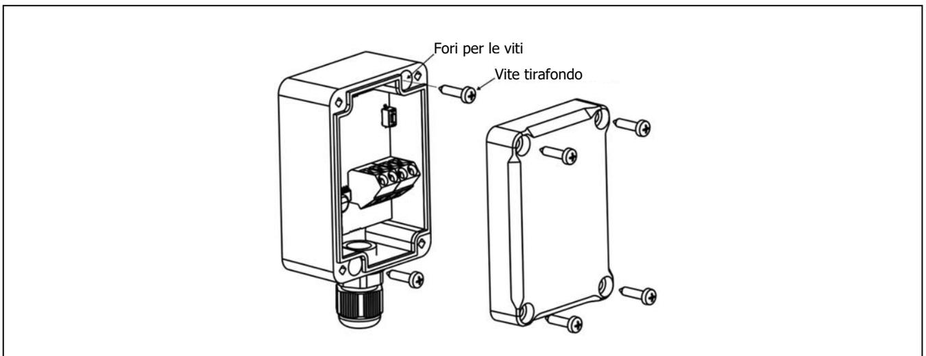
**IMPORTANTE:** la collocazione del modulo radio all'interno di un involucro metallico, ad esempio all'interno della caldaia, in una scatola metallica, ecc. attenerà il segnale radio e quindi interferirà e ridurrà la copertura del segnale radio del modulo.
