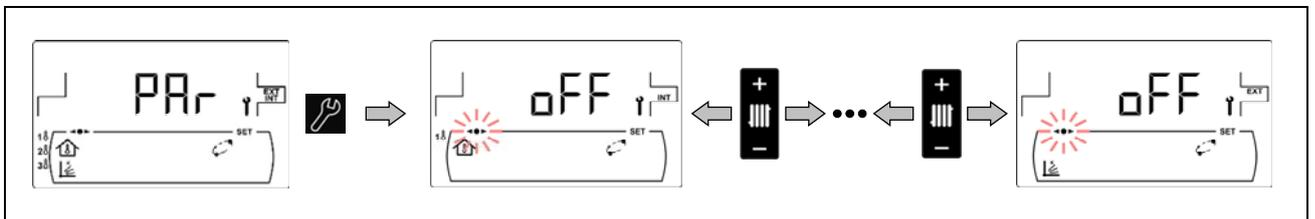
2. Una volta selezionata la zona da abbinare/disabbinare, premendo
