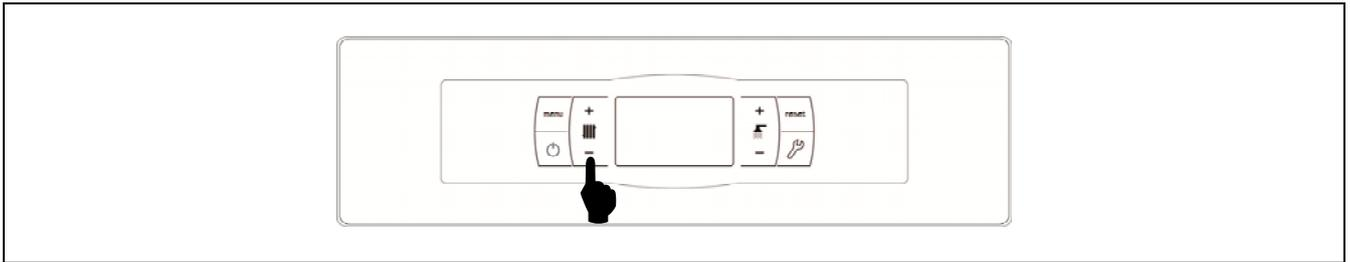
La selezione della temperatura di servizio della caldaia desiderata avviene mediante il selettore tattile indicato in figura. Per selezionare la temperatura desiderata toccare i simboli "+" o "-" per aumentare o ridurre rispettivamente il valore della temperatura. Una volta selezionata la temperatura, in pochi secondi il display tornerà in standby. L'intervallo di set-point della temperatura caldaia selezionabile corrisponde a OFF, 65 - 80°C.
