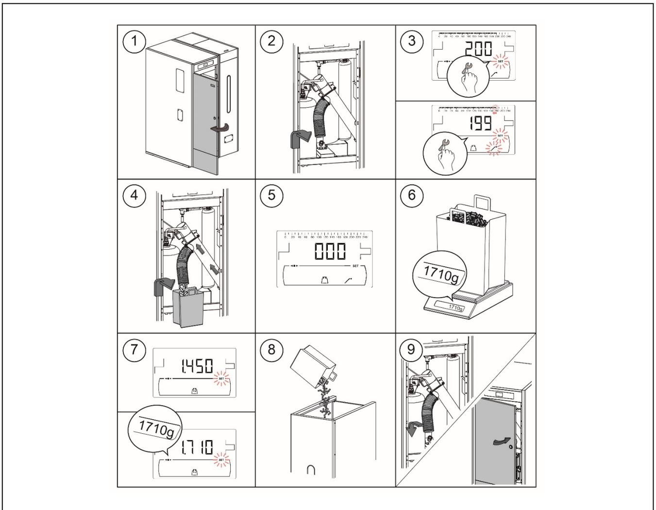
**IMPORTANTE: Eseguire la calibrazione prima dell'avvio della caldaia.**
