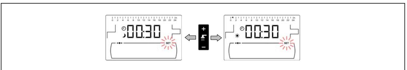
Una volta regolati tutti i periodi di tempo desiderati, premendo un'ultima volta il simbolo 🛠️ si salverà la programmazione impostata e si tornerà al "Menu Configurazione".
