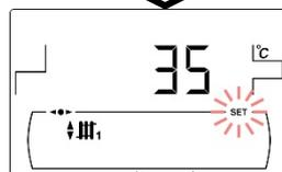
Temperatura di riferimento di ingresso del circuito miscelato n°1, selezionata mediante il relativo selettore tattile (18).
