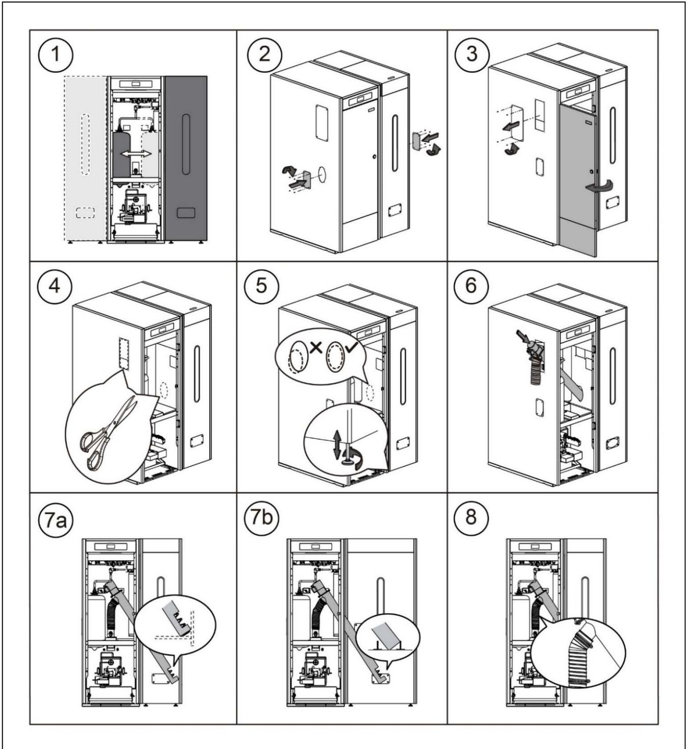
**IMPORTANTE:** Controllare che le fenditure ellittiche sui lati della caldaia e del deposito di riserva siano alla stessa altezza, per consentire la corretta introduzione dell'alimentatore. A tal fine, effettuare le regolazioni necessarie sia in altezza (con i supporti regolabili) sia sulla superficie (posizionando correttamente il deposito di riserva).
