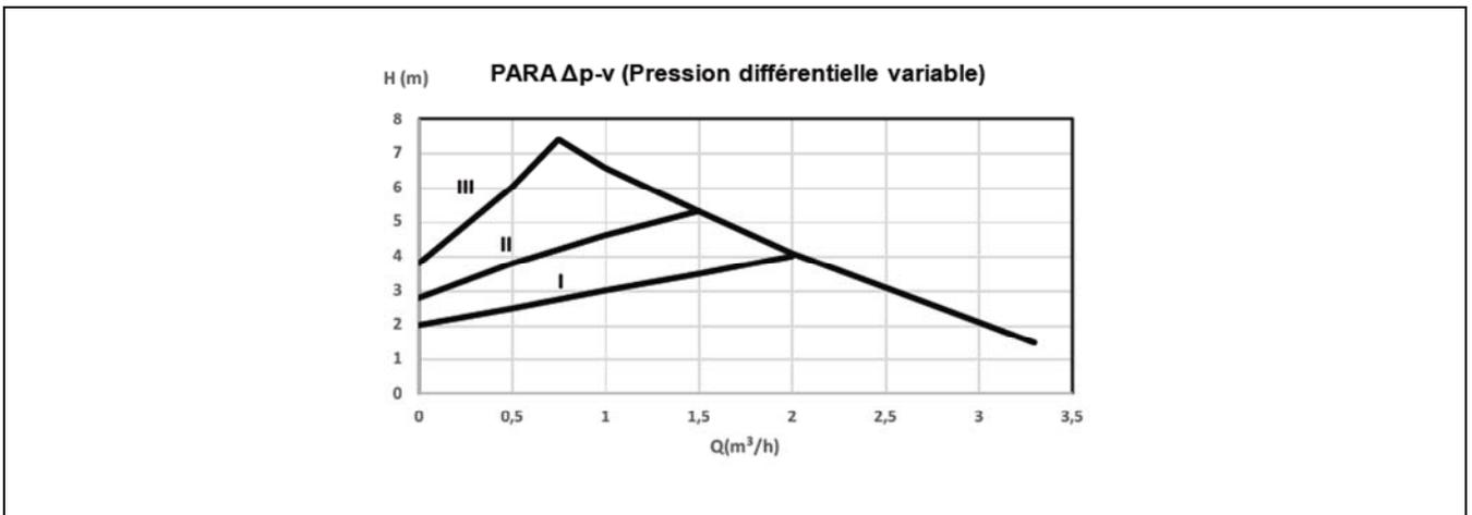
Courbe caractéristique de la pompe de circulation pour le mode de pression différentielle constante:
