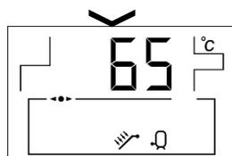
Temperatura effettiva dell'acqua calda sanitaria accumulata nell'accumulatore solare.
