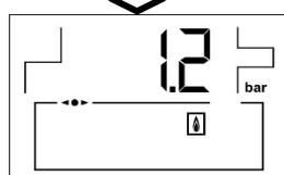
Pressione effettiva della caldaia misurata dal sensore di pressione **(13)**.
