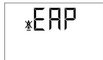
Si verifica quando la pressione della caldaia scende al di sotto di 0,5 bar, evitando che questa funzioni quando l'impianto è privo di acqua a causa di una perdita o per operazioni di manutenzione. Per sbloccare, è necessario riempire nuovamente l'impianto finché il parametro "pressione della caldaia" sul display **(19)** non indica una pressione compresa tra 1 e 1,5 bar.
