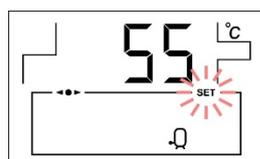
Temperatura di setpoint dell'A.C.S. dell'accumulatore di supporto, selezionata tramite il selettore touch corrispondente **(27)**.
