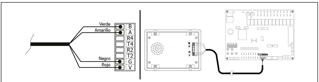
El cable suministrado con la bomba de calor es de 5 metros de longitud. Si fuera necesario, podrá alargarse hasta una distancia máxima de 30 metros (sección entre 0,25 ÷ 1,25 mm<sup>2</sup>).
