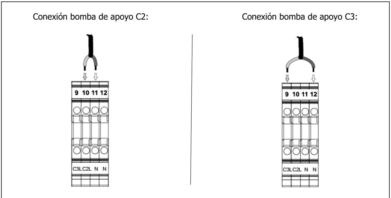
**IMPORTANTE:** Siempre que se intervenga sobre la instalación eléctrica de la bomba de calor, asegurarse de que ésta está desconectada de la red eléctrica.
