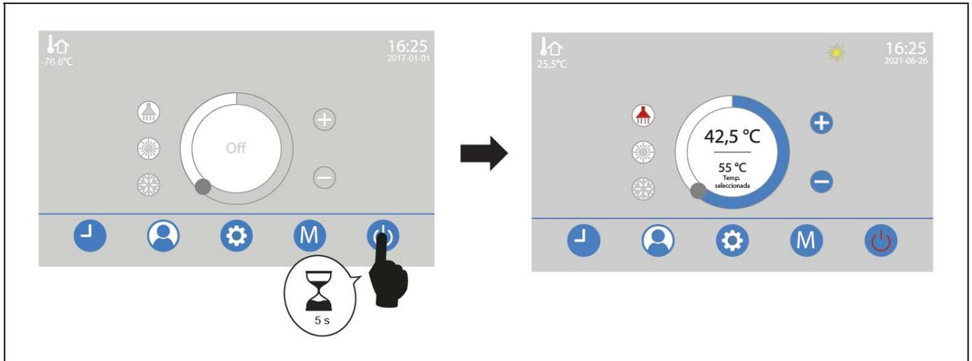
Para apagar la bomba de calor pulsar el botón de apagado (9) durante 5 segundos
