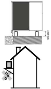
Si se instala en una terraza o fachada, la salida de condensados deberá conducirse a un desagüe, para evitar las molestias y/o daños provocados por el goteo de agua de los condensados. Si la instalación se realiza en una región donde la temperatura pueda ser inferior a 0 °C durante un largo periodo de tiempo, verificar que la presencia de hielo no represente ningún peligro.
