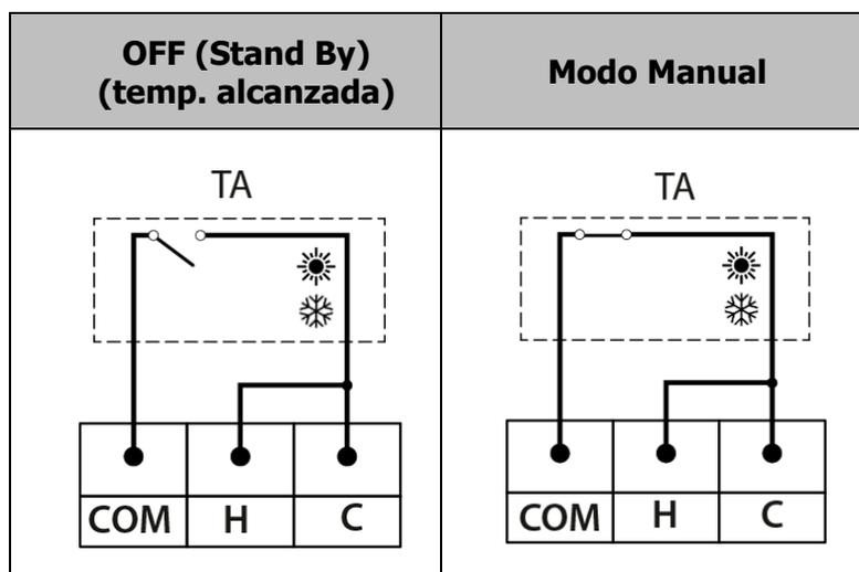
Las bornas **C (26)**, **H (25)** y **COM (24)** se suministran de fábrica con un puente conectado en cada una de ellas, por lo que, para instalar este tipo de termostato será necesario quitar **los dos** puentes y conectar el termostato según lo descrito en la siguiente figura, siendo necesario un puente entre las entradas **C (26)** y **H (25)**:
