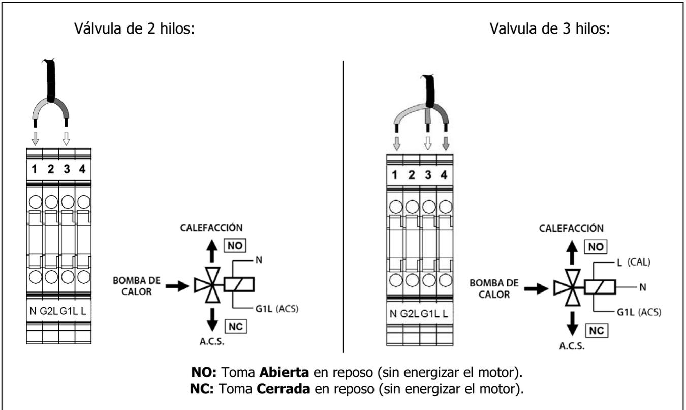
**IMPORTANTE:** Siempre que se intervenga sobre la instalación eléctrica de la bomba de calor, asegurarse de que ésta está desconectada de la red eléctrica.
