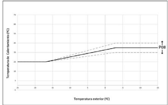
**NOTA: Un incorrecto ajuste de las curvas de funcionamiento puede provocar que la instalación de calefacción no genere el confort deseado en la vivienda, no calentando adecuadamente en condiciones climáticas extremas de mucho frío y/o calentando excesivamente en condiciones climáticas de calor.**
