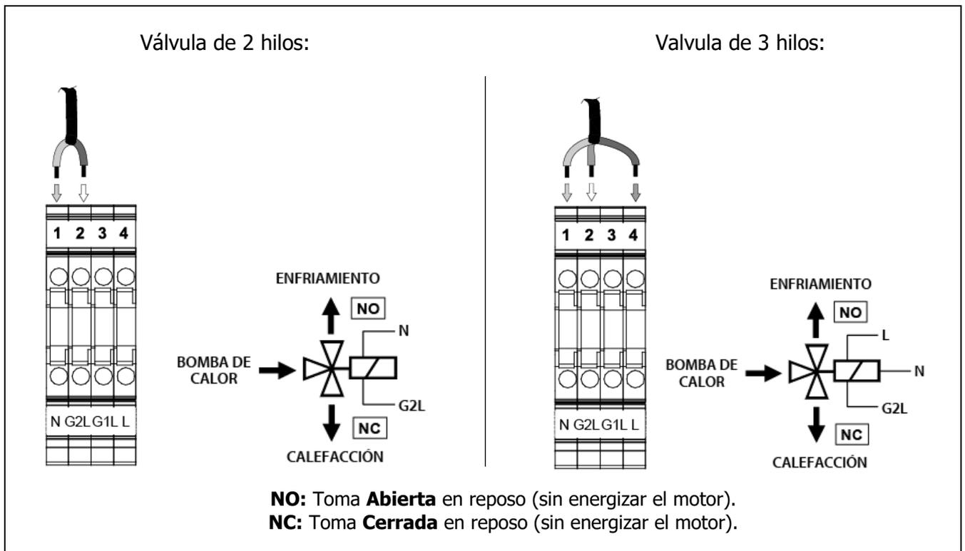
**IMPORTANTE:** Siempre que se intervenga sobre la instalación eléctrica de la bomba de calor, asegurarse de que ésta está desconectada de la red eléctrica.
