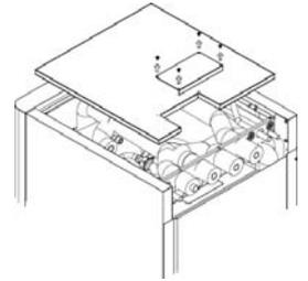
2. Desmontar la sujeción de tubos, destornillando los 6 tornillos de fijación.
