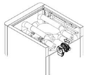
7. Desmontar la tapa de la puerta del módulo hidráulico, para acceder a las regletas de conexiones.
