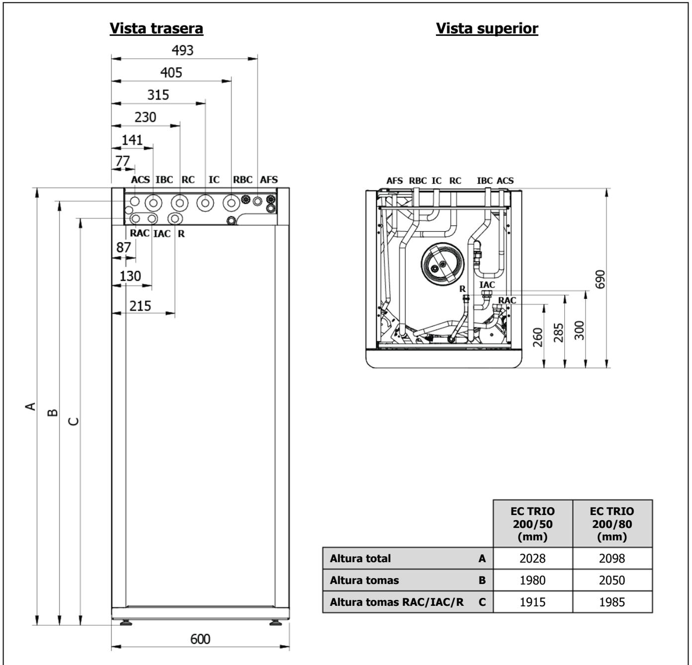
**IC:** Ida Calefacción/Climatización, Ø22 (racor de 1" M).
