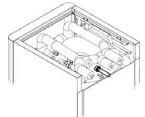
6. Montar la bomba de circulación en su lugar, respetando la dirección de flujo indicado en la figura y asegurándose bien el sellado de la conexión.
