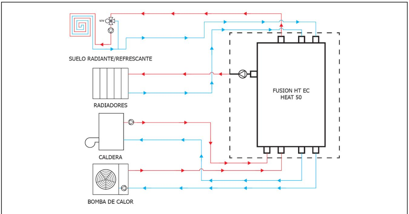
**ATENCIÓN:** Las tomas de ida y retorno de la bomba de calor DUAL CLIMA EC y de la caldera se deberán conectar hidráulicamente al módulo FUSION EC HEAT 50 mediante las tomas correspondientes indicadas en el apartado "Croquis y medidas" de este manual.
