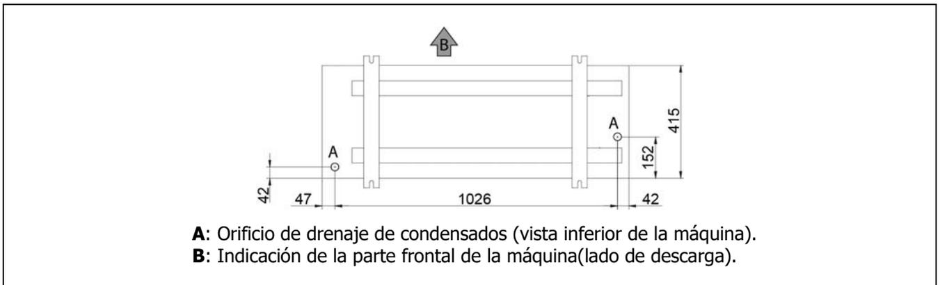
Preferiblemente instalar el aparato en un lugar bien drenado, para ello, se recomienda el prever un lecho de grava, arena o similar debajo de dicho orificio. Si el orificio de drenaje de la bomba de calor está cubierto por una base de montaje o por el suelo, elevar la unidad para dejar por debajo de ella un espacio libre de al menos 100 mm.
