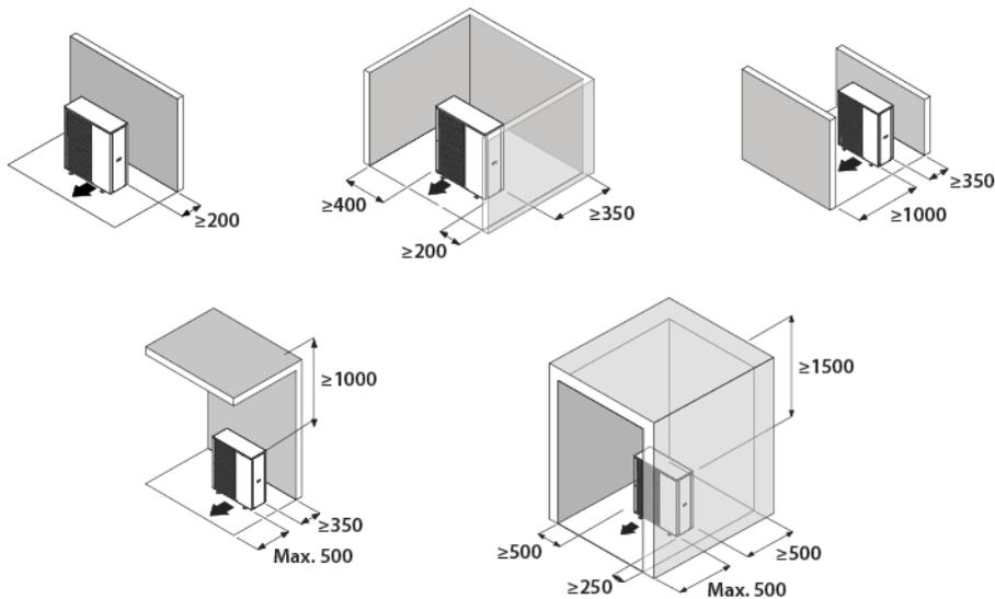
Separaciones mínimas para la instalación de una unidad (mm).
