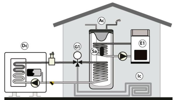
Para realizar correctamente la instalación eléctrica de la sonda de ACS, de la válvula de 3 vías (**G1**), así como de la resistencia de apoyo (**E1**), leer detenidamente el apartado "*Conexiones Eléctricas*" de este manual.
