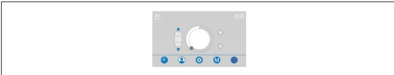
**IMPORTANT :** Assurez-vous d'avoir sélectionné correctement le mode de fonctionnement, au niveau de la pompe à chaleur ainsi qu'au niveau du thermostat, afin d'assurer que les mêmes modes de fonctionnement ont été sélectionnés sur les deux.
