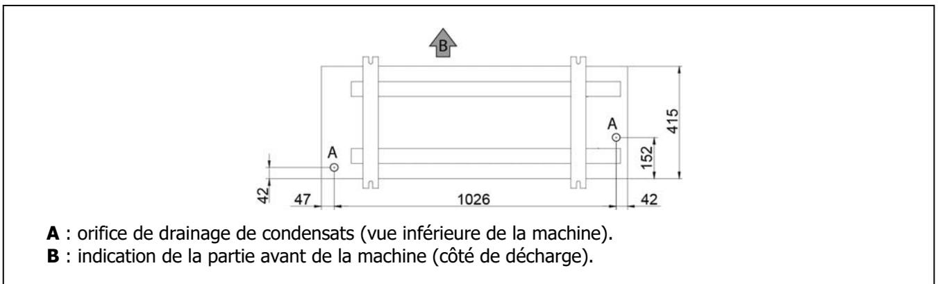
De préférence, installer l'appareil dans un endroit bien drainé en prévoyant si besoin est un lit de gravier, de sable ou similaire sous cet orifice. Si l'orifice de drainage de la pompe est couvert par une base de montage ou par le sol, soulever l'appareil pour laisser dessous un espace libre d'au moins 100 mm.
