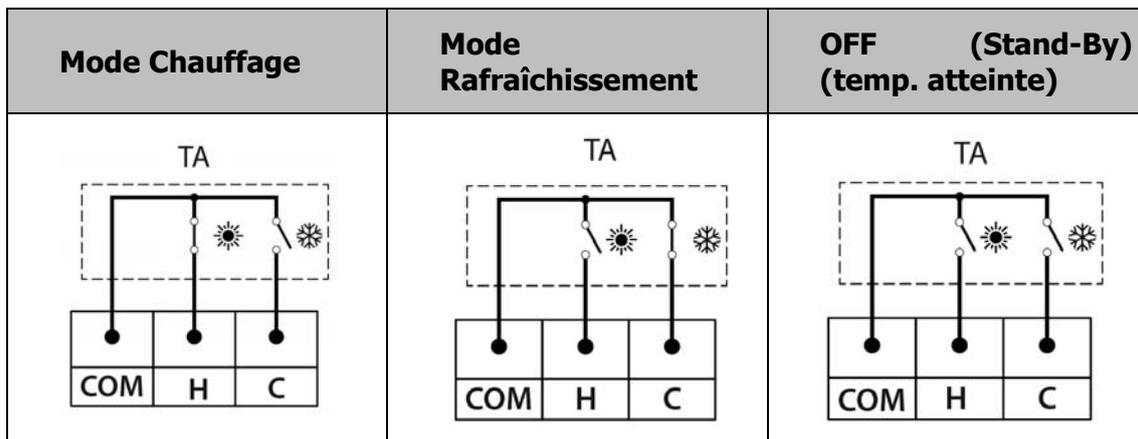
Les bornes **C (26)**, **H (25)** et **COM (24)** sont fournies en usine avec un pont connecté sur chacune d'entre elles, il est donc nécessaire pour installer ce type de thermostat de retirer **les deux** ponts et de brancher le thermostat en suivant les indications de la figure suivante :
