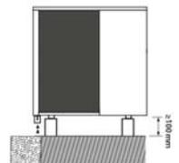
S'il est monté sur une terrasse ou en façade, la sortie des condensats doit être conduite vers un écoulement pour éviter toute gêne et/ou dommage dus à la fuite d'eau des condensats. Si l'installation est réalisée dans une région où la température peut tomber en dessous de 0 °C pendant une longue période, vérifier que la présence de glace ne présente aucun danger.
