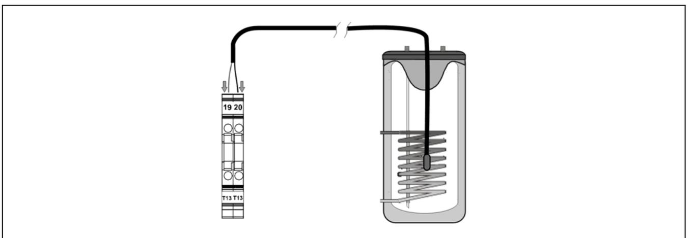
La sonde fournie avec la pompe à chaleur mesure 5 mètres de long. Si nécessaire, elle peut être rallongée jusqu'à une distance maximale de 20 mètres (section entre 0,25 ÷ 1,25 mm<sup>2</sup>).
