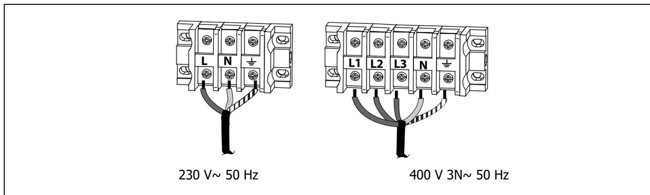
Le dimensionnement des câbles d'alimentation doit respecter à tout moment les normes et les règlements en vigueur. Toutefois, diverses caractéristiques et dimensions recommandables sont précisées ci-dessous à titre d'orientation :
