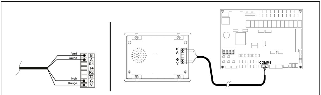
Le câble fourni avec la pompe à chaleur mesure 5 mètres de long. Si nécessaire, elle peut être rallongée jusqu'à une distance maximale de 30 mètres (section entre 0,25 ÷ 1,25 mm<sup>2</sup>).
