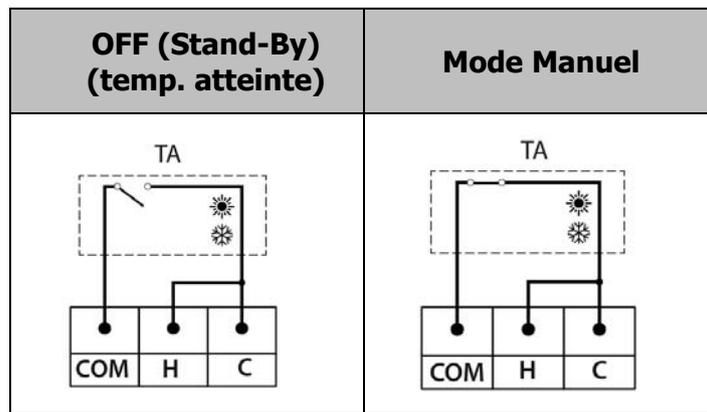
Les bornes **C (26)**, **H (25)** et **COM (24)** sont fournies en usine avec un pont connecté à chacune d'entre elles. C'est pourquoi, pour installer ce type de thermostat, **les deux** ponts devront être retirés et le thermostat raccordé selon les instructions indiquées sur la figure suivante, un pont entre les entrées **C (26)** et **H (25)** étant nécessaire:
