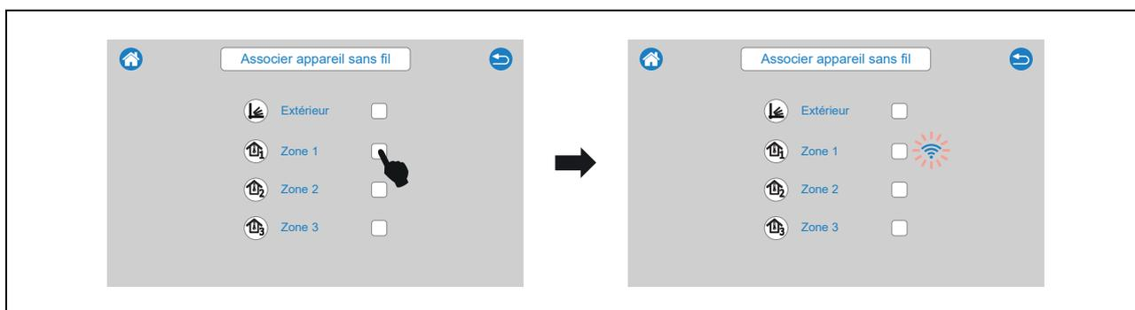
2. L'**appariement** doit être réalisé depuis le dispositif sans fil lui-même. En fonction du type de dispositif sans fil (**Confort iC** ou **Sonda iC**), l'appariement s'effectue de manière différente (voir le manuel d'instructions fourni avec chaque dispositif pour plus de détails) :
