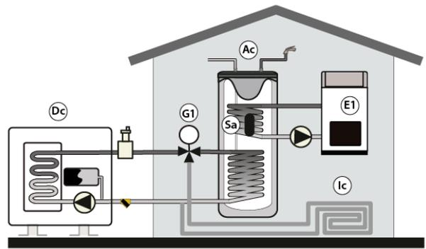
Pour réaliser correctement l'installation électrique de la sonde d'ECS, de la vanne à 3 voies (**G1**) et de la résistance d'appoint (**E1**), lire attentivement le paragraphe « *Branchements électriques* » de cette notice.
