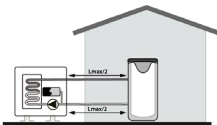
$L_{max}$  = Longueur maximale du tuyau d'installation indiquée.
