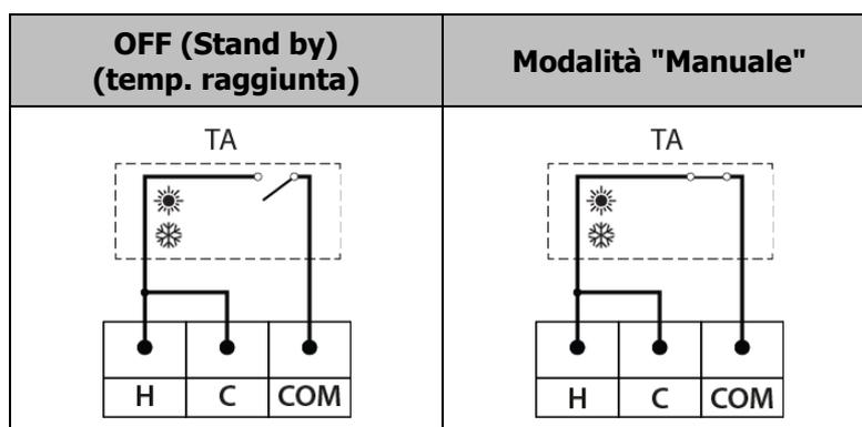
I morsetti **H (1)**, **C (2)** e **COM (3-4)** vengono forniti di fabbrica con un ponte connesso a ciascuno di essi, pertanto, per installare questo tipo di termostato, è necessario rimuovere **i due** ponti e collegare il termostato come descritto nella seguente figura, ed è necessario collegare un ponte tra gli ingressi **H (1)** e **C (2)**:
