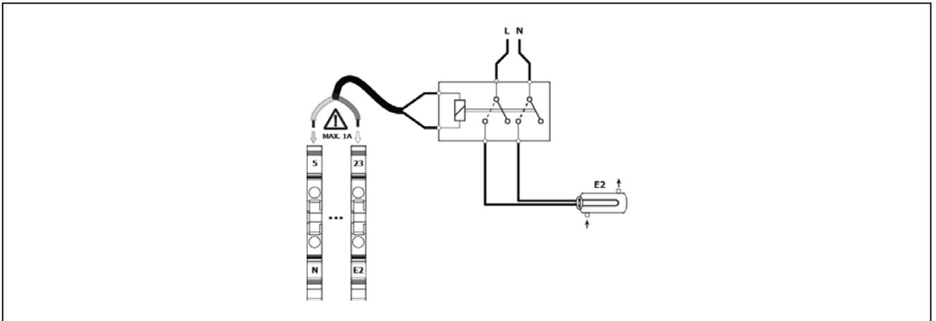
**DOMUSA TEKNIK** offre opzionalmente un kit con resistenza e relè di potenza inclusi, appositamente studiato per essere installato nella pompa di calore **DUAL CLIMA HT EC PRO** .
