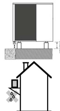
In caso di installazione in un terrazzo o su una facciata, lo scarico della condensa deve essere indirizzato verso uno scarico, per evitare disagi e/o danni causati dal gocciolamento dell'acqua di condensa. Se l'installazione viene effettuata in una regione in cui la temperatura può rimanere inferiore a 0 °C per un lungo periodo di tempo, verificare che la presenza di ghiaccio non rappresenti alcun pericolo.
