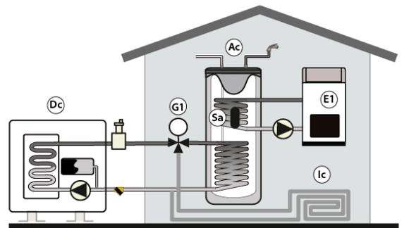
I collegamenti elettrici della sonda di temperatura dell'ACS, della valvola deviatrice a 3 vie (**G1**), nonché della fonte di supporto (**E1**), si effettuano nelle morsettiere dei collegamenti del modulo interno **Easy Connect** (vedere "Istruzioni per l'installazione del modulo interno").
