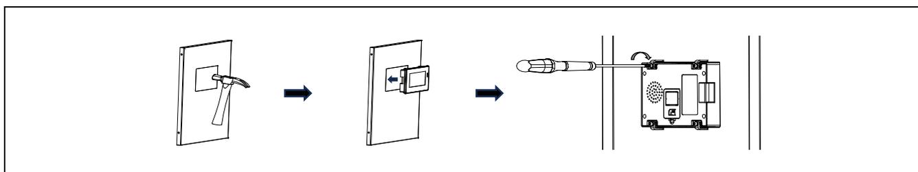
Una volta fissata la centralina, far passare il cavo di collegamento fornito con il modulo di comunicazione dal modulo di comunicazione al punto in cui si trova la centralina e collegare l'estremità con il terminale bianco al morsetto "**COMM4**" sulla scheda elettronica del modulo interno. Quindi collegare il connettore a 8 vie verde in dotazione, come indicato nella figura seguente, e collegarlo al retro della centralina di controllo:
