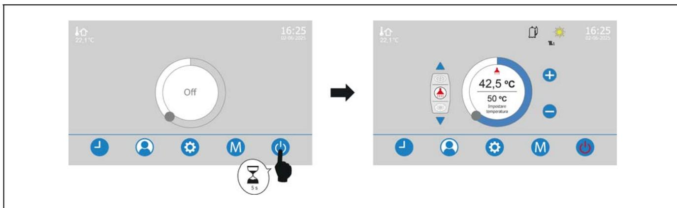
Per spegnere la pompa di calore, tenere premuto il pulsante a sfioramento di spegnimento
