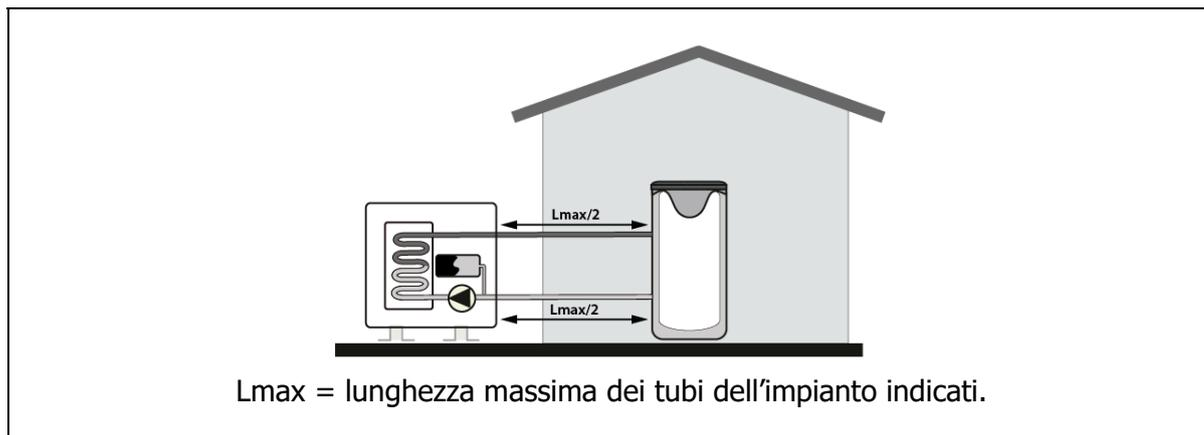
**ATTENZIONE:** Nel calcolo della distanza massima ammissibile è necessario tenere conto della singola perdita di carico generata da eventuali elementi idraulici aggiunti all'impianto, come gomiti, filtri, valvole a 3 vie, ecc., riducendo la distanza effettiva massima disponibile.
