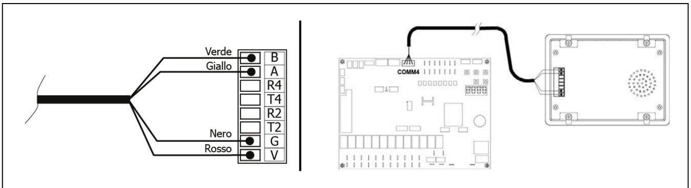
Il cavo fornito con il modulo interno è lungo 5 metri. Se necessario, può essere prolungato fino a una lunghezza massima di 50 metri (sezione del cavo compresa tra 0,25-1,25 mm<sup>2</sup>).
