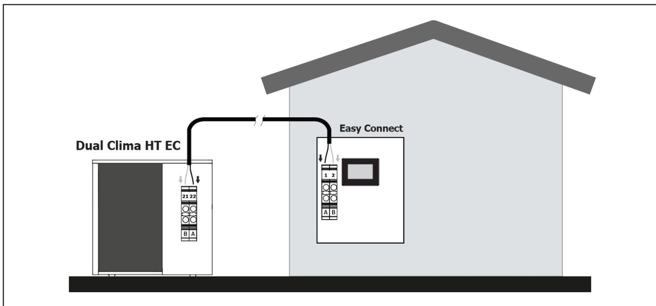
**ATTENZIONE:** È fondamentale rispettare la polarità nel collegamento tra il modulo interno **Easy Connect** e l'unità esterna **DUAL CLIMA HT EC PRO**.
