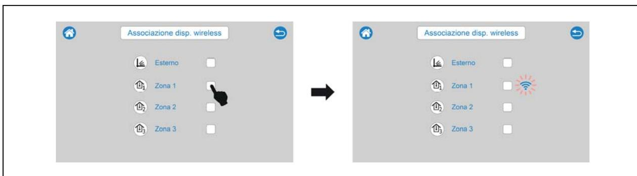
2. L'**associazione** deve essere effettuata dal dispositivo wireless stesso. A seconda del tipo di dispositivo wireless (**Confort iC** o **Sonda iC**), l'associazione verrà eseguita in modo diverso (per i dettagli, consultare il manuale di istruzioni fornito con ciascun dispositivo):
