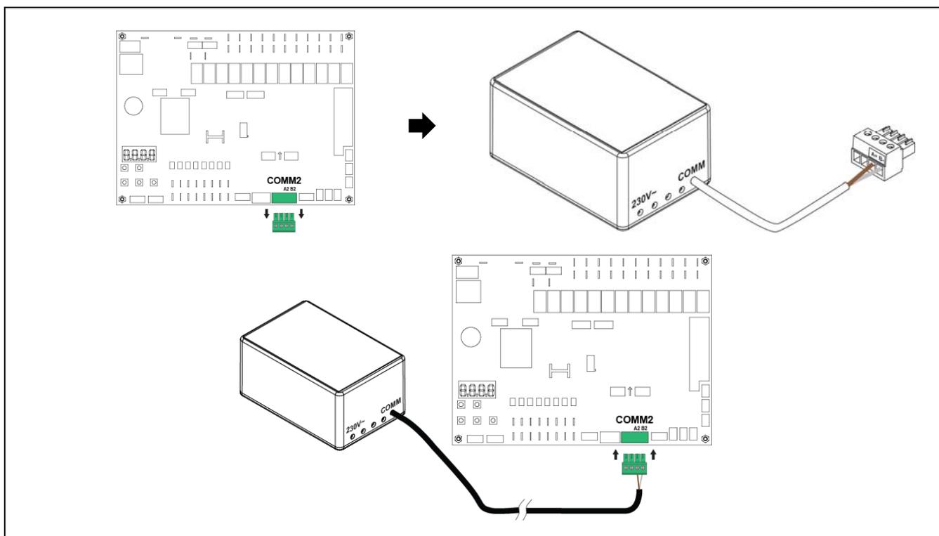
I cavi forniti in dotazione con il modulo **iConnect** sono lunghi 5 metri. Se necessario, possono essere allungati. La lunghezza del cavo di comunicazione tra l'unità interna e il modulo **iConnect** non deve essere superiore a 100 metri (sezione del cavo compresa tra 0,25-1,25 mm<sup>2</sup>).
