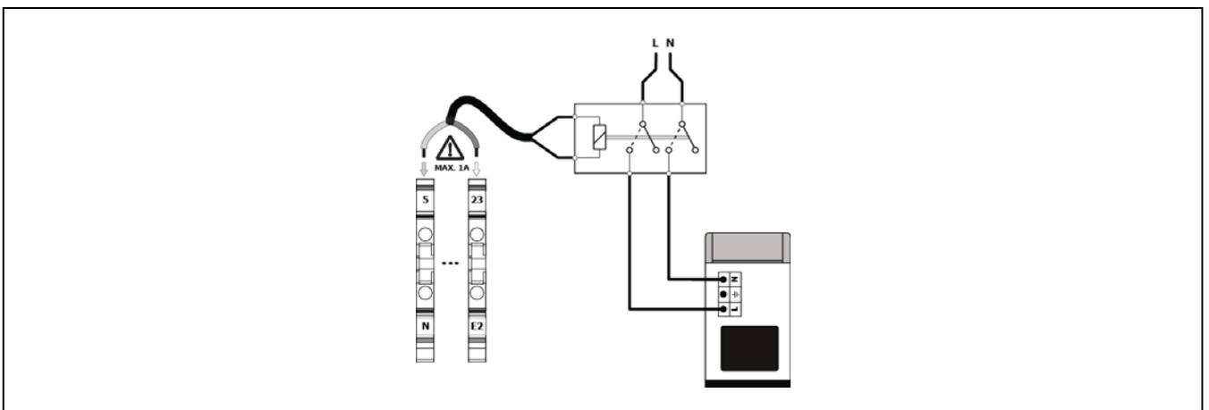
**ATTENZIONE:** Il relè di uscita **E2** ha una capacità di consumo massima di **1A**, quindi se la fonte di supporto e tutti i suoi componenti superano questo consumo elettrico è necessario inserire un relè di potenza.
