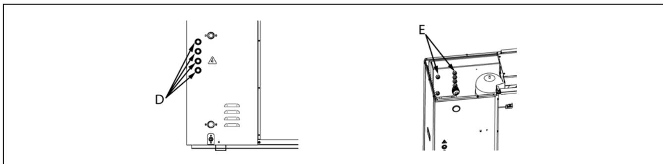
La **pompa di calore DUAL CLIMA HT EC PRO** è predisposta per il collegamento a 230 V~50 Hz o 400 V 3N~ 50 Hz (a seconda che il modello sia monofase o trifase) sui morsetti indicati nella figura (vedi "Schema dei collegamenti"). I morsetti di alimentazione elettrica si trovano all'interno della macchina, è necessario aprire lo sportello anteriore e accedere alle schede elettroniche anteriori. **Non dimenticare di effettuare la messa a terra.**
