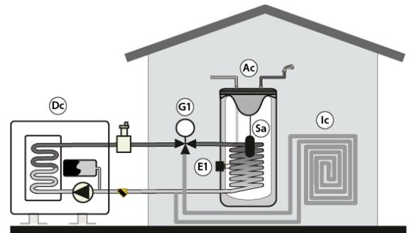
Opzionalmente è possibile installare una resistenza di supporto (**E1**).
