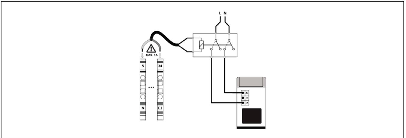
**ATTENZIONE:** Il relè di uscita E1 ha una capacità di consumo massima di 1A, quindi se la fonte di supporto e tutti i suoi componenti superano questo consumo elettrico è necessario inserire un relè di potenza.
