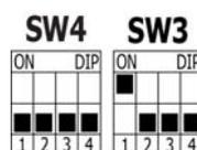
Ogni unità esterna dovrà essere numerata da **1** a **4** (vedere "Funzioni aggiuntive"). La pompa di calore **Dc1** è la principale, mentre le altre sono unità secondarie che entrano in funzione se l'unità principale non raggiunge da sola il parametro di riscaldamento o raffrescamento impostato. A tale scopo, le uscite **E3** (riscaldamento) ed **E4** (raffrescamento) del modulo interno **Easy Connect** principale (**Dc1**),
