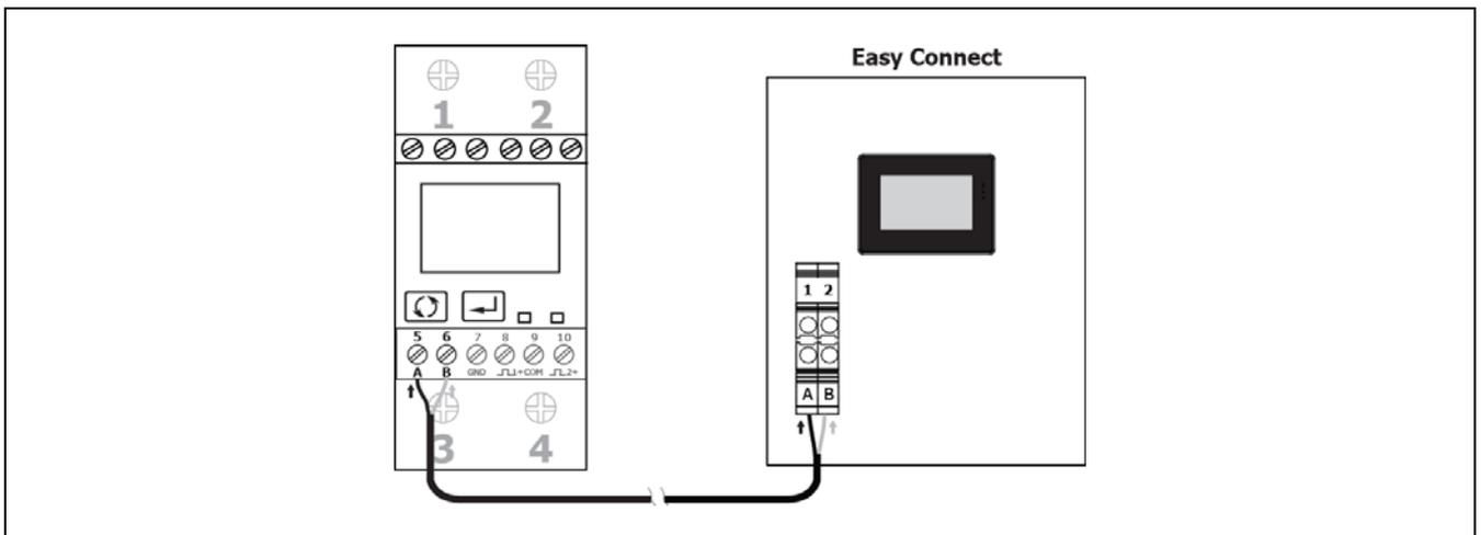
**ATTENZIONE:** È fondamentale rispettare la polarità del collegamento tra il modulo interno Easy Connect e il misuratore di energia bidirezionale.
