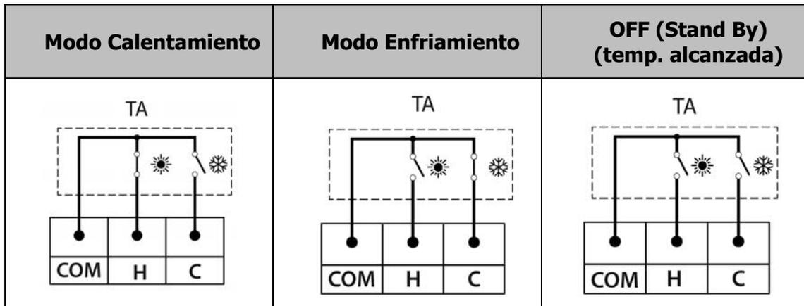
Las bornas **C (26)**, **H (25)** y **COM (24)** se suministran de fábrica con un puente conectado en cada una de ellas, por lo que, para instalar este tipo de termostato será necesario quitar **los dos** puentes y conectar el termostato según lo descrito en la siguiente figura:
