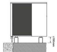
Si se instala en una terraza o fachada, la salida de condensados deberá conducirse a un desagüe, para evitar las molestias y/o daños provocados por el goteo de agua de los condensados. Si la instalación se realiza en una región donde la temperatura pueda ser inferior a 0 °C durante un largo periodo de tiempo, verificar que la presencia de hielo no represente ningún peligro.
