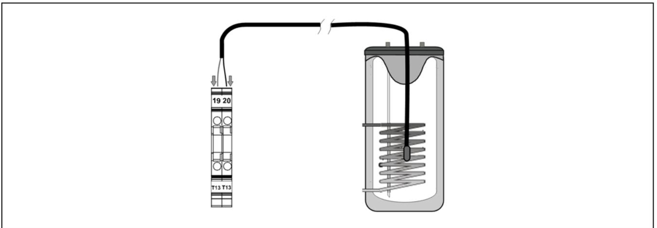
La sonda suministrada con la bomba de calor es de 5 metros de longitud. Si fuera necesario, podrá alargarse hasta una distancia máxima de 20 metros (sección entre 0,25 ÷ 1,25 mm<sup>2</sup>).
