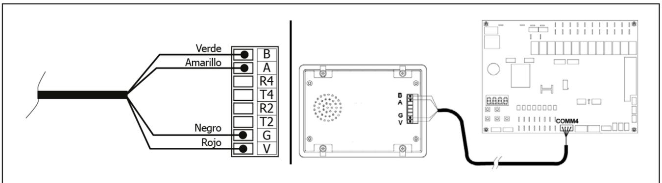
El cable suministrado con la bomba de calor es de 5 metros de longitud. Si fuera necesario, podrá alargarse hasta una distancia máxima de 30 metros (sección entre 0,25 ÷ 1,25 mm<sup>2</sup>).
