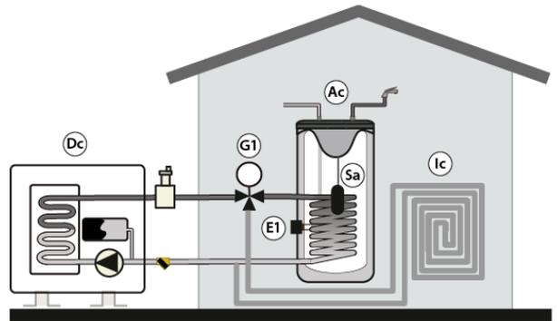
Además, opcionalmente se podrá instalar una resistencia de apoyo (**E1**), mediante la cual se podrán obtener temperaturas de ACS superiores a 55 °C.
