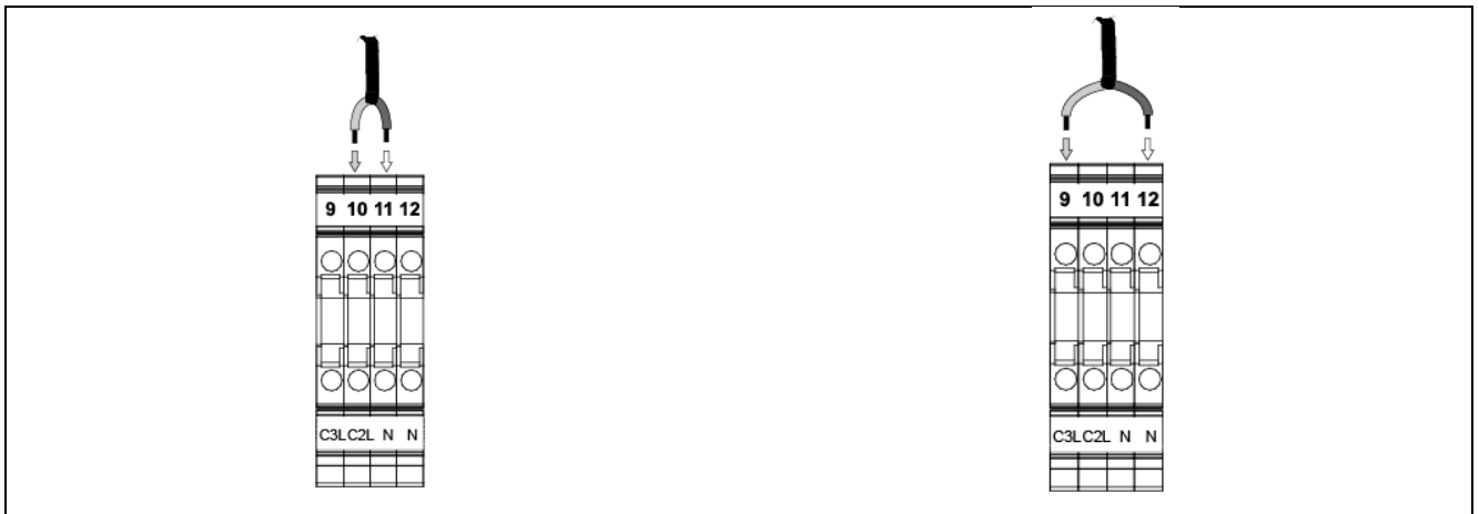
Imagen: Conexión de una bomba de circulación de apoyo en Calefacción/Climatización (C2)
